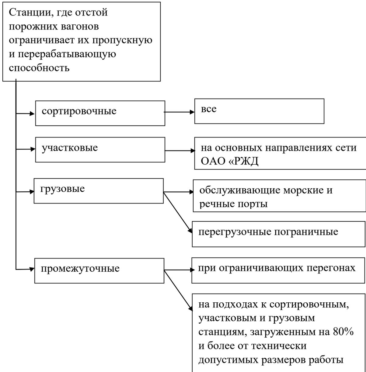
Рисунок 4.3 – Станции, где отстой порожних вагонов ограничивает их пропускную и перерабатывающую способность
