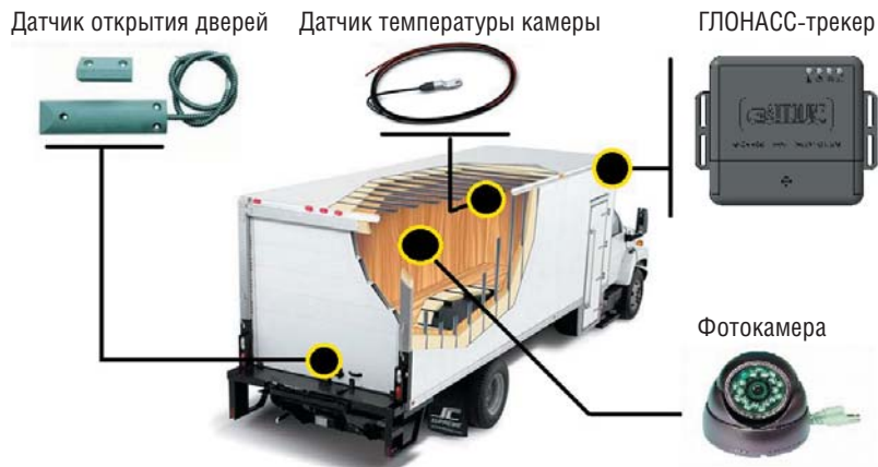
Рис. 3. Схема системы контроля температур автомобильного рефрижератора
