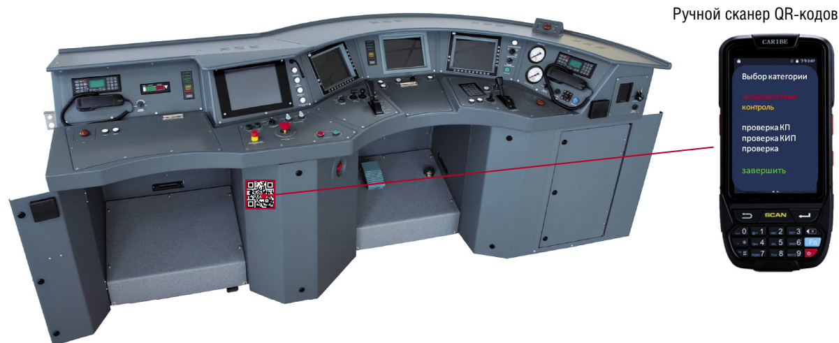
Рис. 3. Пример размещения QR-кода в кабине машиниста электропоезда ЭС1 «Ласточка»
