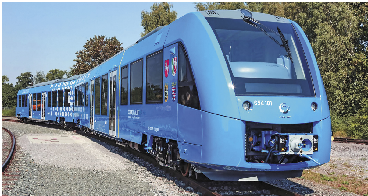
Рис. 3. Первый в мире поезд на водороде Coradia iLint фирмы Alstom
