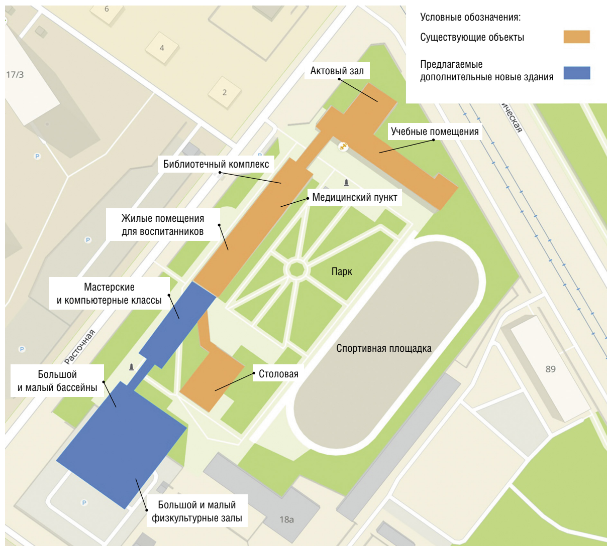
Рис. 4. Схема размещения помещений при блочной системе застройки
