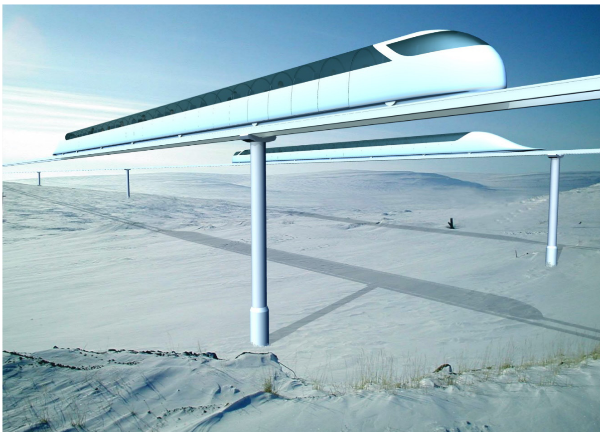
Рис. 5. Высокоскоростной юнимобиль с протяженным корпусом (вариант)
