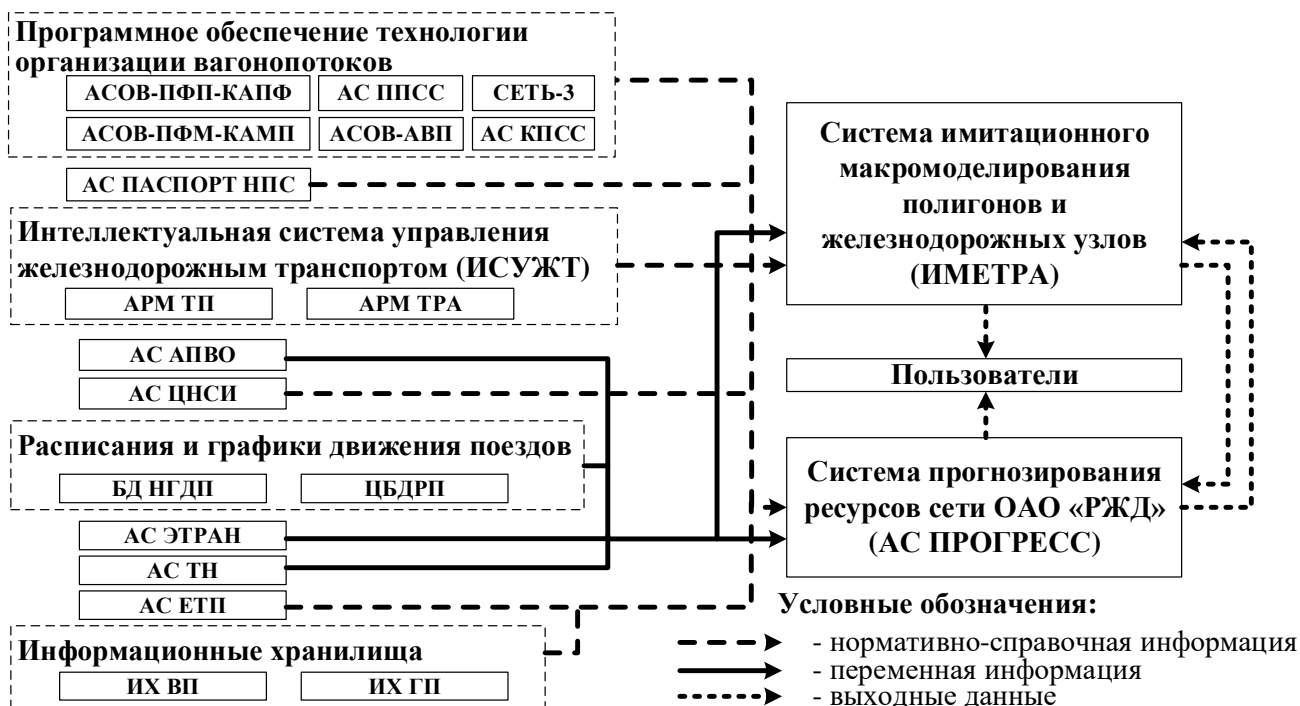
Рисунок 5 – Информационная структура гибридного модельного комплекса
