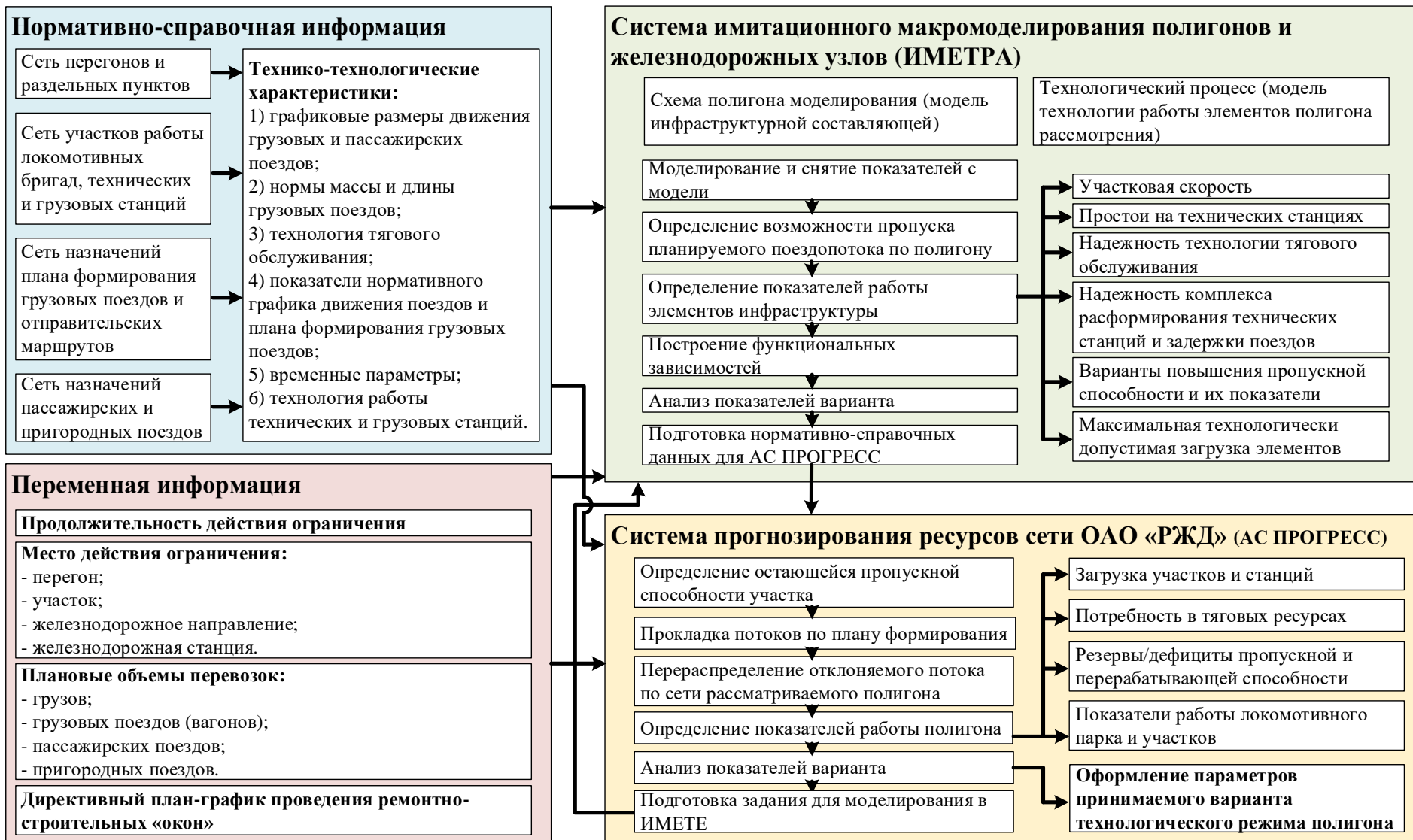
Рисунок 4 – Функциональная структура гибридного модельного комплекса
