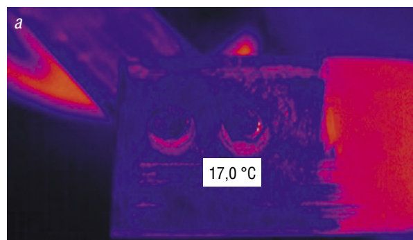
Рис. 6. Термограмма соединения «алюминий — медь» ( I = 2500 \text{ А} , t = 10 \text{ мин.} ): а — без отработки, б — с обработкой галлиевым сплавом
