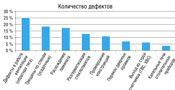
Рис. 1. График распределения дефектов по значимости
