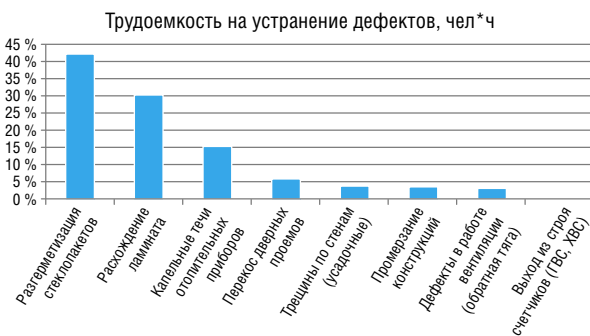
Рис. 5. График распределения дефектов по трудоёмкости
