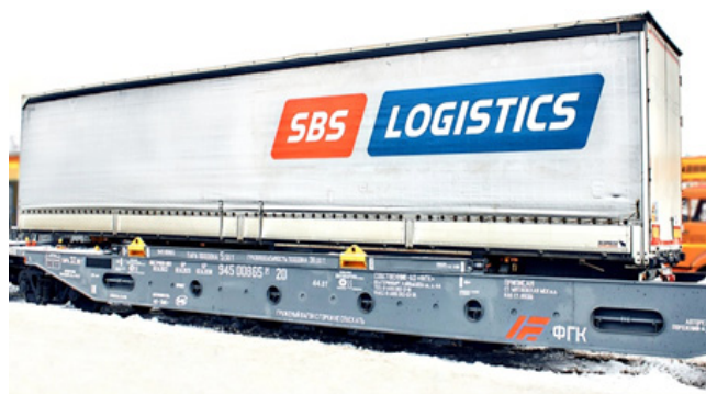
Рис. 4. Автомобильный полуприцеп на платформе колодецкого типа производства ЗМК, г. Энгельс (модель 13-6701, 2023 г.)
