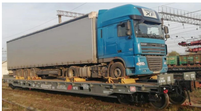
Рис. 3. Автовоз на платформе модели 13-5205 производства УВЗ (2019 г.)
