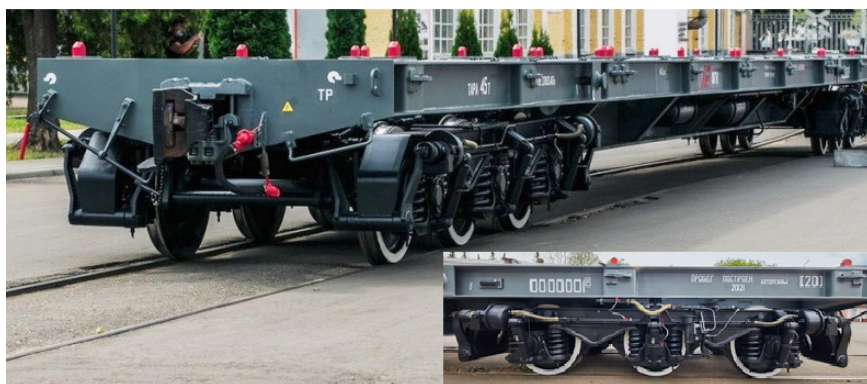
Рис. 5. Общий вид фитинговой платформы модели 13-6704 и ее тележки
