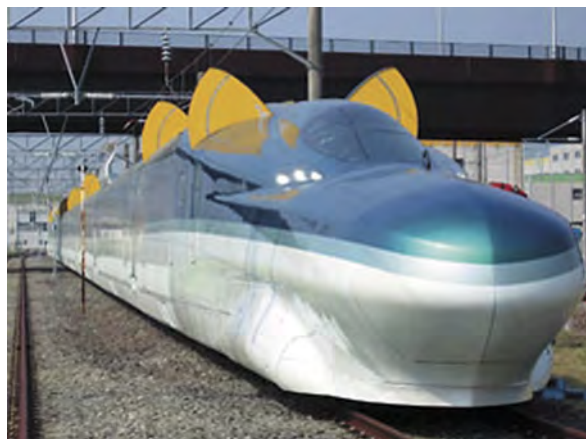
Рис. 1. Высокоскоростной электропоезд с аэродинамическим тормозом
