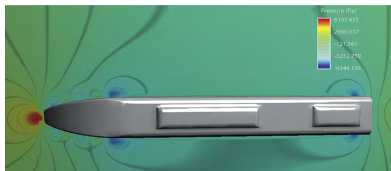
Рис. 5. Распределение зон давления воздушного потока (вид сверху)
