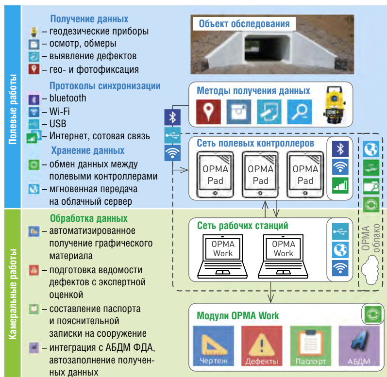
Рис. 4. Схема реализации обмена данными между продуктами OPMA при обследовании водопропускной трубы
