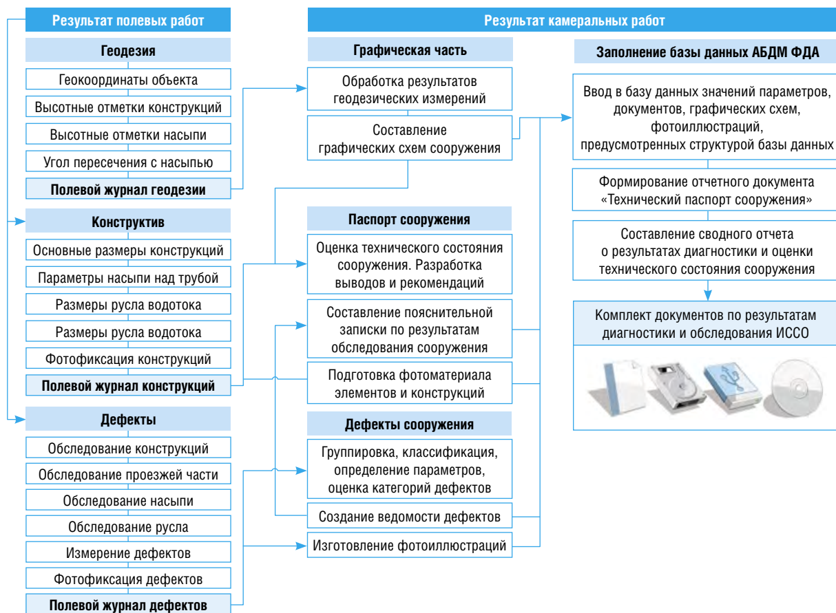
Рис. 5. Схема формирования комплексной оценки технического состояния сооружения
