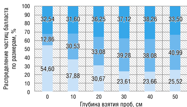
Рис. 1. Распределение частиц балластной призмы по фракциям на различных глубинах: ■ — < 2 мм; ■ — 2–10 мм; ■ — > 10 мм
