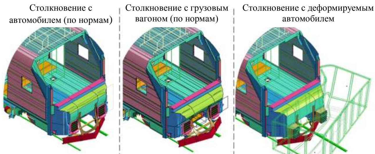
Рисунок 11 – Необратимые деформации устройства поглощения энергии
