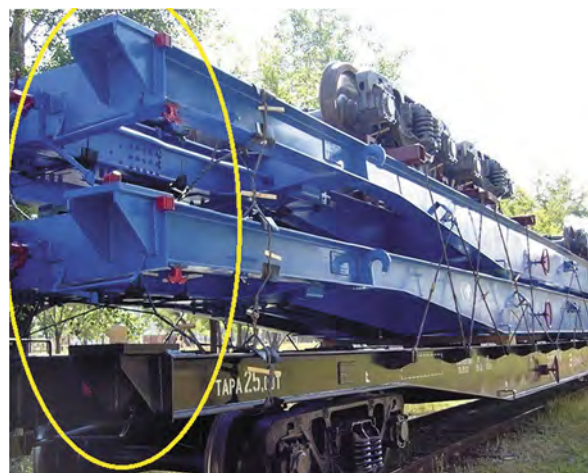
Рис. 2. Вынос крайних опор за раму платформы мод. 23-469-07
