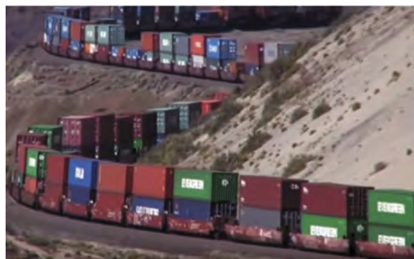
Рис. 3. Фрагмент контейнерного поезда с двухъярусной погрузкой контейнеров
