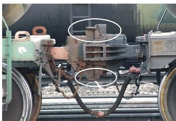
Рис. 5. Ограничители от саморасцепа на корпусе автосцепки
