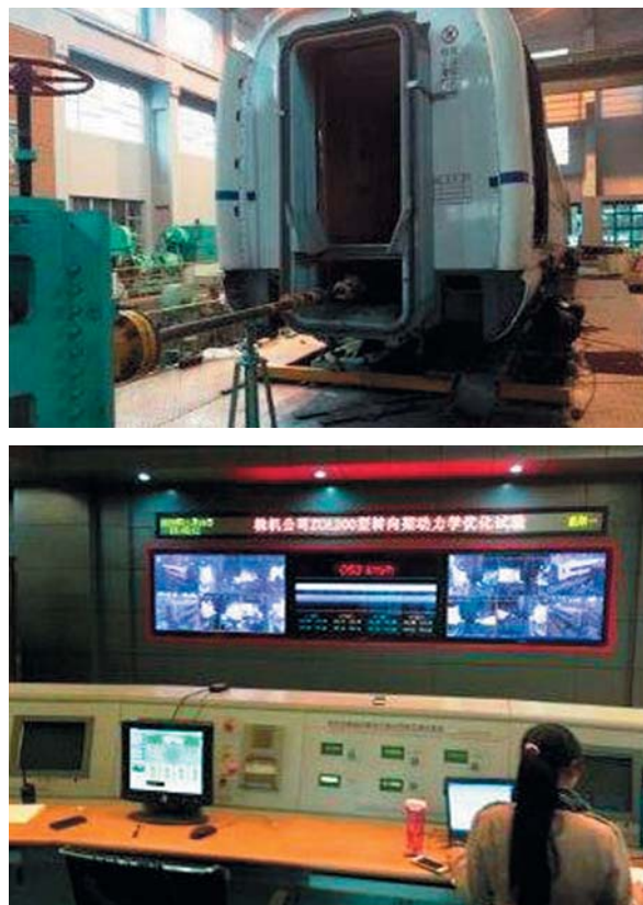
Рис. 1. Испытательная катковская станция университета Чэнду и центр контроля и управления
