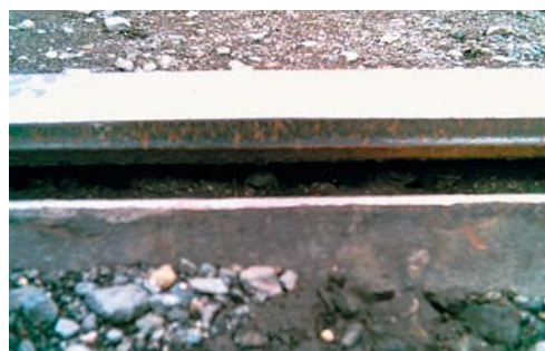
Рис. 1. Боковой износ головки рельса в кривом участке пути R = 128 м (Северский трубный завод)
