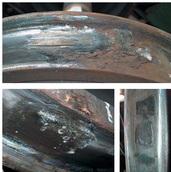
Рис. 1. Дефекты на бандаже (колесе) вагона МВПС
