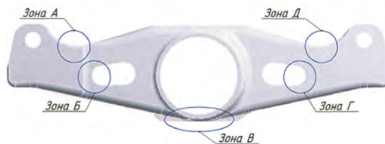
Рис. 3. Зоны особого контроля корпуса буксы в процессе циклических испытаний
