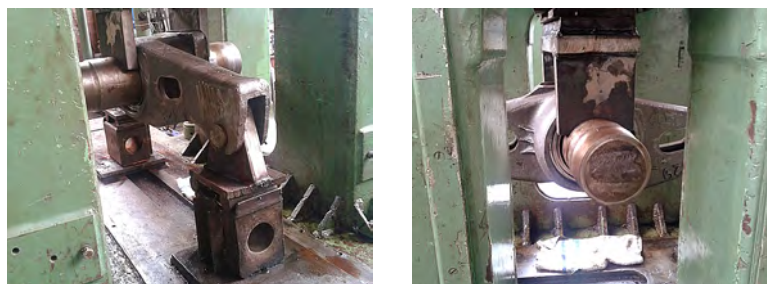
Рис. 2. Общий вид усталостных испытаний корпуса буксы
