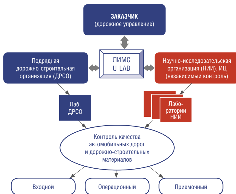
Рис. 2. Блок-схема независимого контроля с применением ЛИМС U-LAB в системе контроля качества автодорог и материалов
