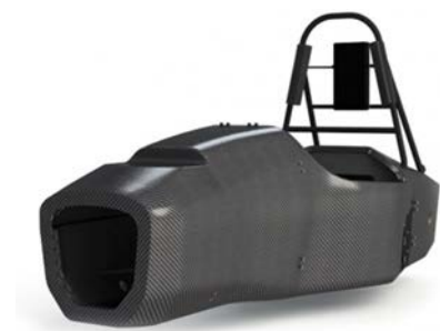
Рис. 3. Составной композитный монокок болида класса «Формула Студент»
