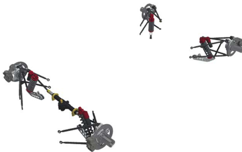
Рис. 1. Конфигурация подвески болида «Формула Студент» FS USURT 2019
