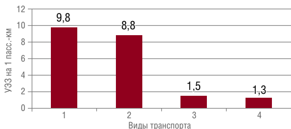
Рис. 3. Удельные энергетические затраты на различных видах транспорта: 1 — самолеты; 2 — легковые автомобили; 3 — междугородние автобусы; 4 — скоростные железные дороги
