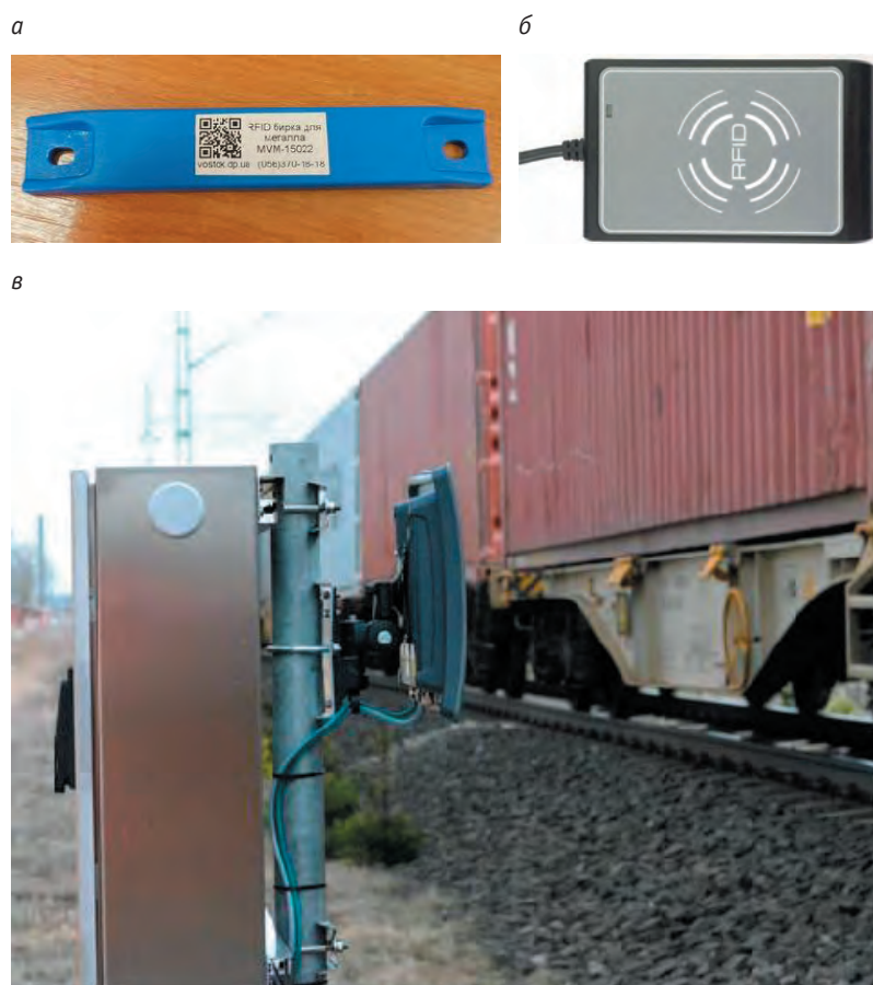
Рис. 9. RFID-система: а — RFID-метка (UHF); б — RFID-считыватель; в — RFID-антенна
