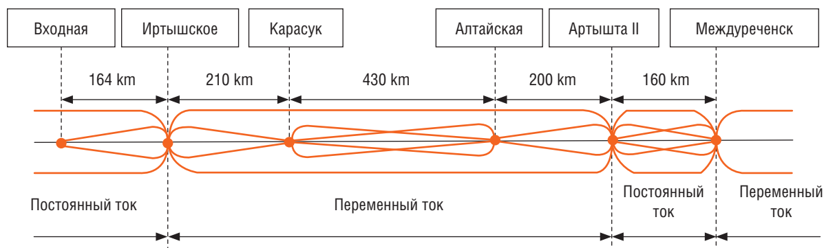
Рис. 5. Существующая схема участков эксплуатации электровозов и локомотивных бригад на линии Междуреченск — Входная
