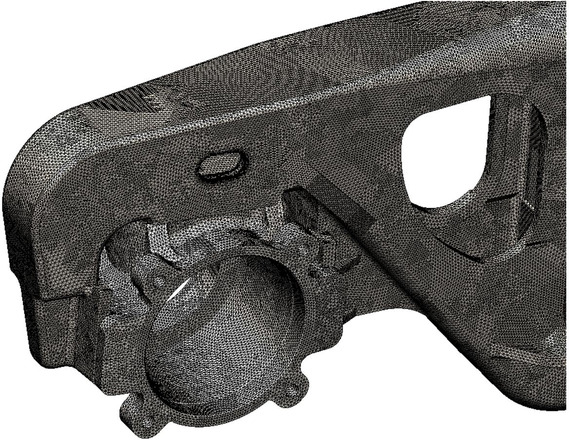
Рисунок 43 – Фрагмент конечноэлементной модели конструкции боковой рамы
