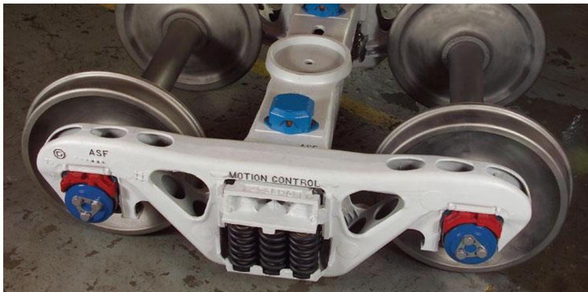
Рисунок 13 – Тележка «Motion Control»
