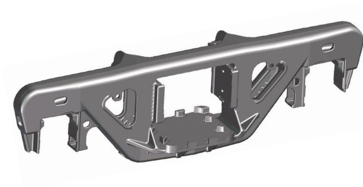
Рисунок 14 – Боковая рама тележки модели 18-9836
