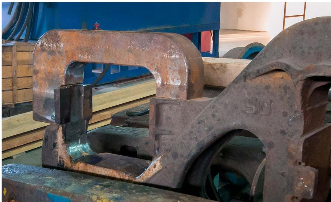
Рисунок 49 – Боковая рама, оборудованная предложенным техническим средством (повернуто на 180°)
