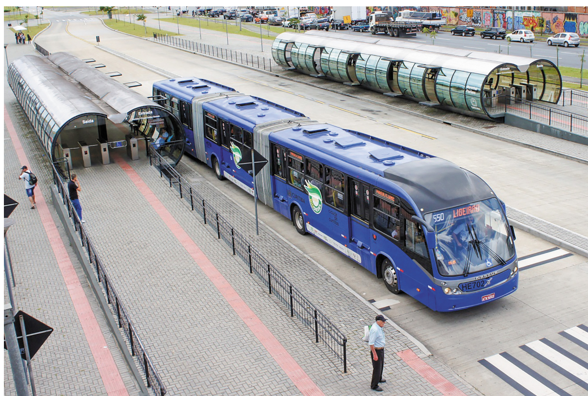
Рис. 4. Подвижной состав двойного сочленения на линии скоростного автобуса
