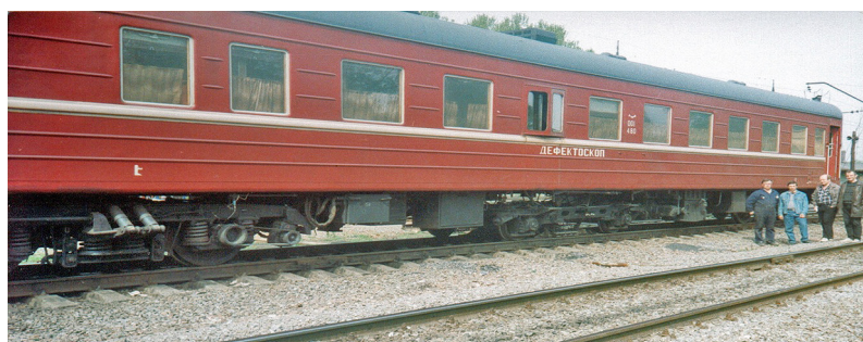
Рис. 3. Совмещенный вагон-дефектоскоп ПС-483
