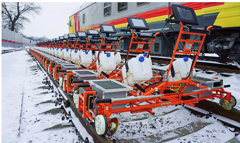
Рис. 6. Дефектоскопная диагностическая тележка «СПРУТ»
