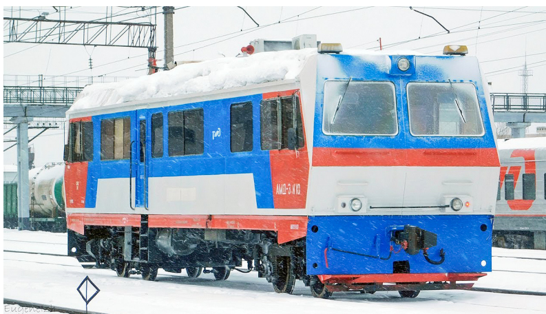
Рис. 4. Автомотриса дефектоскопная АМД-3
