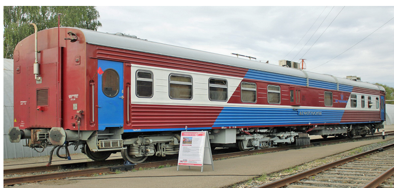
Рис. 2. Совмещенный вагон-дефектоскоп «АВИКОН-03М»
