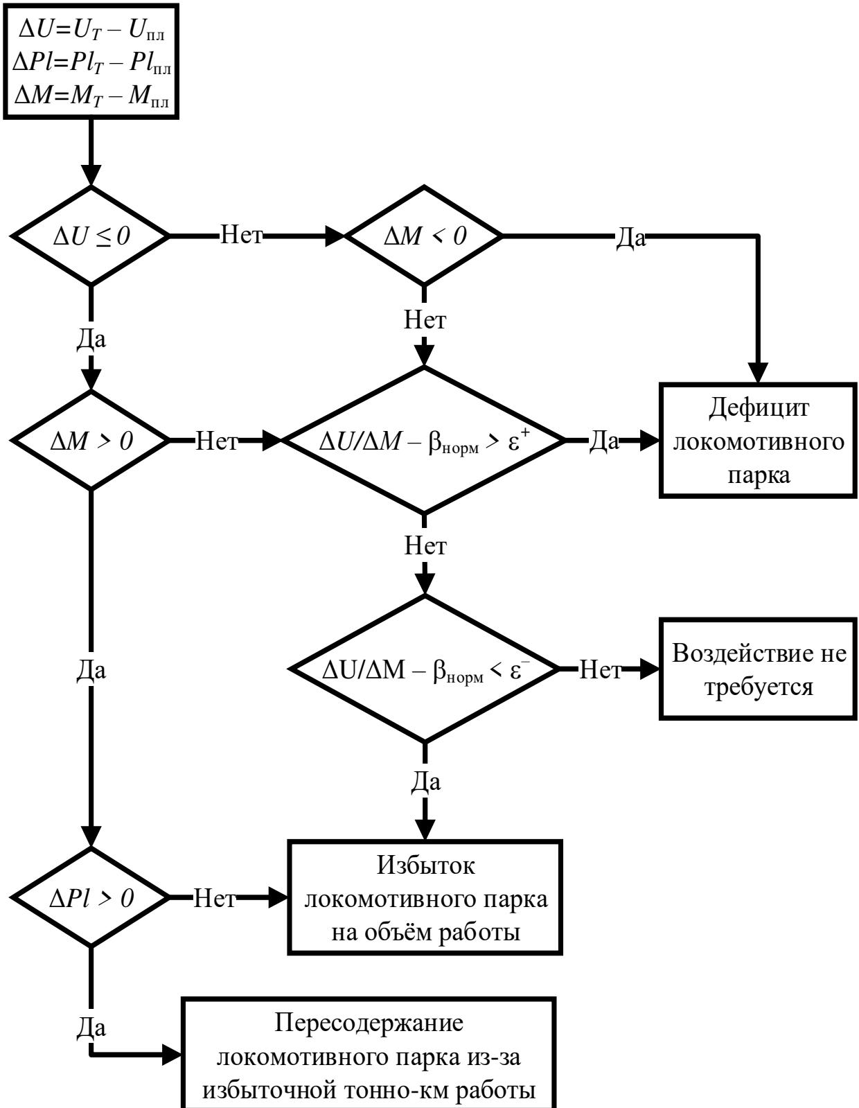
Рисунок 4.4 – Укрупненный алгоритм оценки использования поездных локомотивов грузового движения
