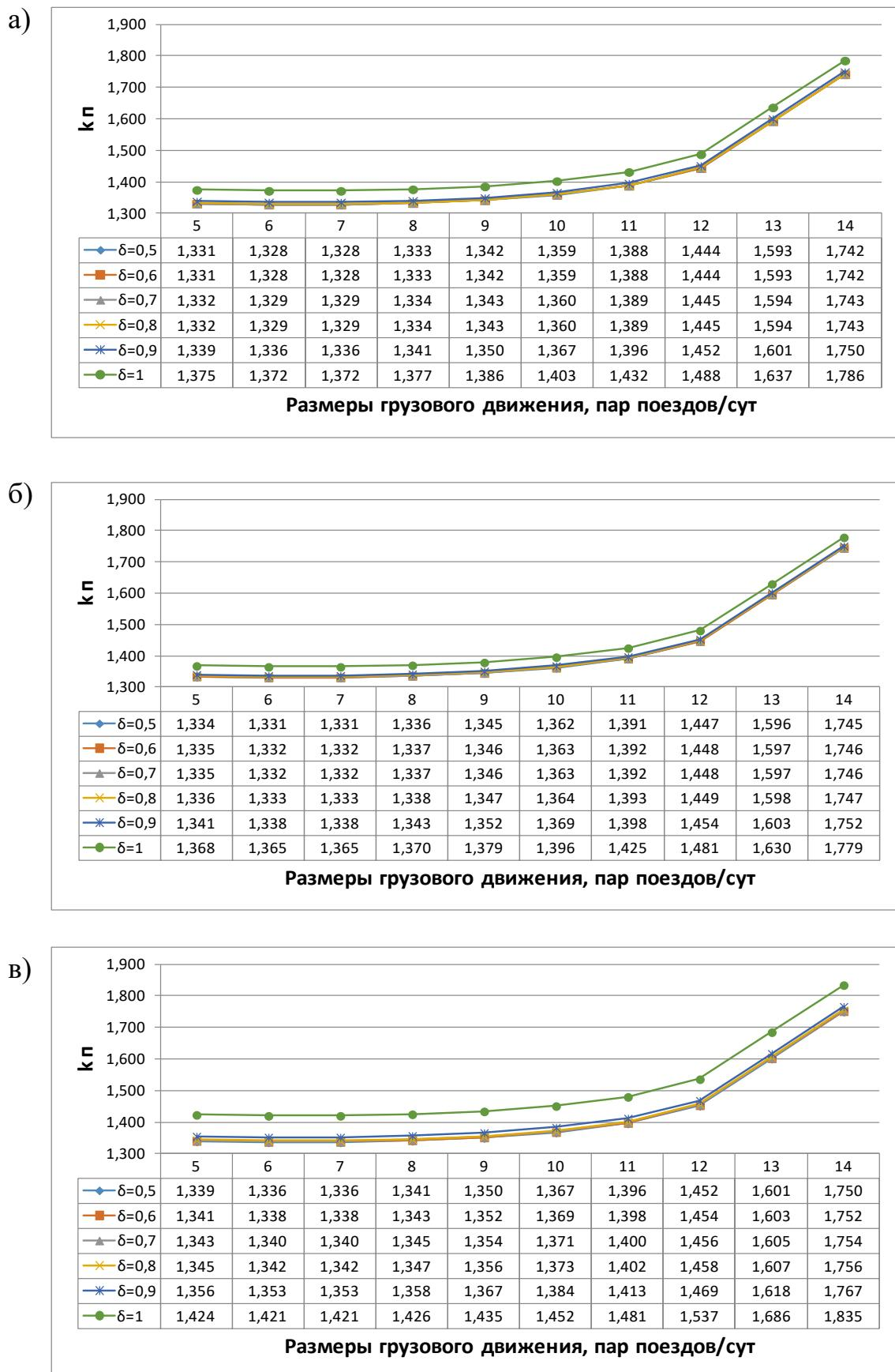
Рисунок 2.11– Зависимость  $k_{\pi} = f(n_{\text{гр}}, \delta)$  для однопутного участка А – Ч: а) без учета враждебного элемента на подходе; б) с загрузкой враждебного элемента  $\gamma_{\text{вход}} = 0,2$ ; в) с загрузкой враждебного элемента  $\gamma_{\text{вход}} = 0,9$
