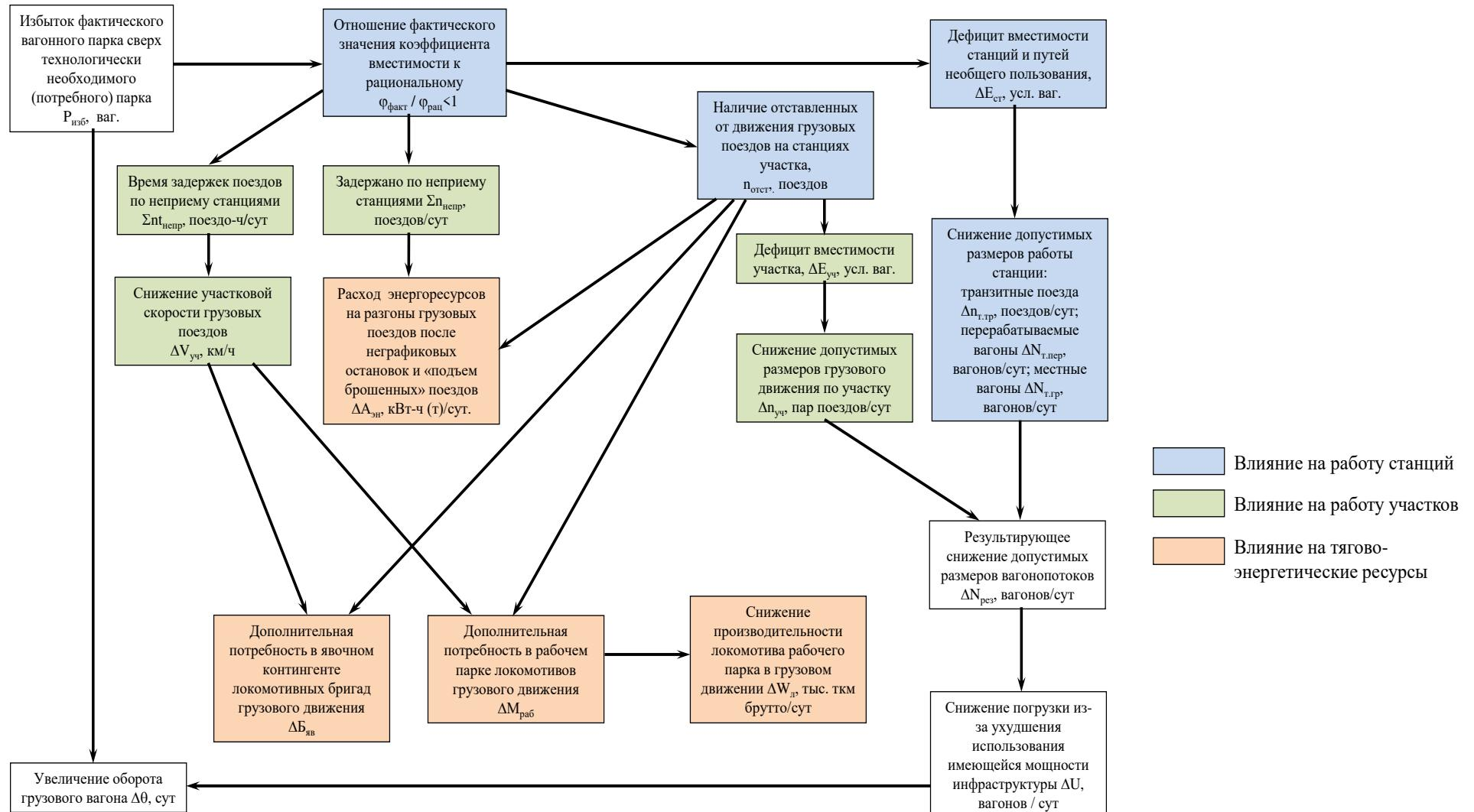
Рисунок 2.5 – Схема оценки влияния избыточного вагонного парка на эффективность и результативность перевозочного процесса
