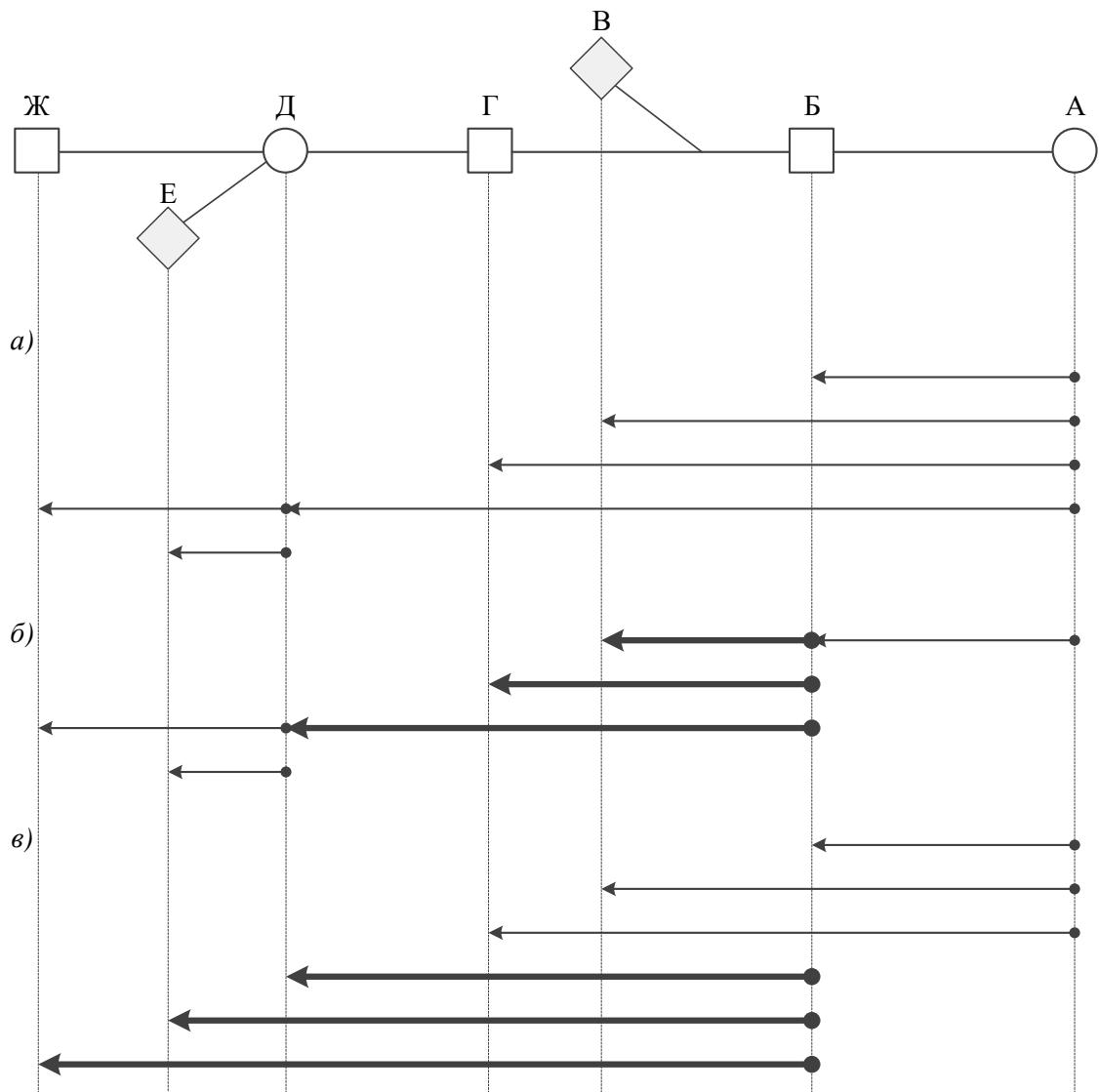
Рисунок 3.7 – Корректировка плана формирования в помощь станции, испытывающей затруднения: а) нормативный план формирования поездов; б) разгрузка сортировочной станции А от назначений формируемых поездов; в) разгрузка сортировочной станции Д от переработки вагонопотоков
