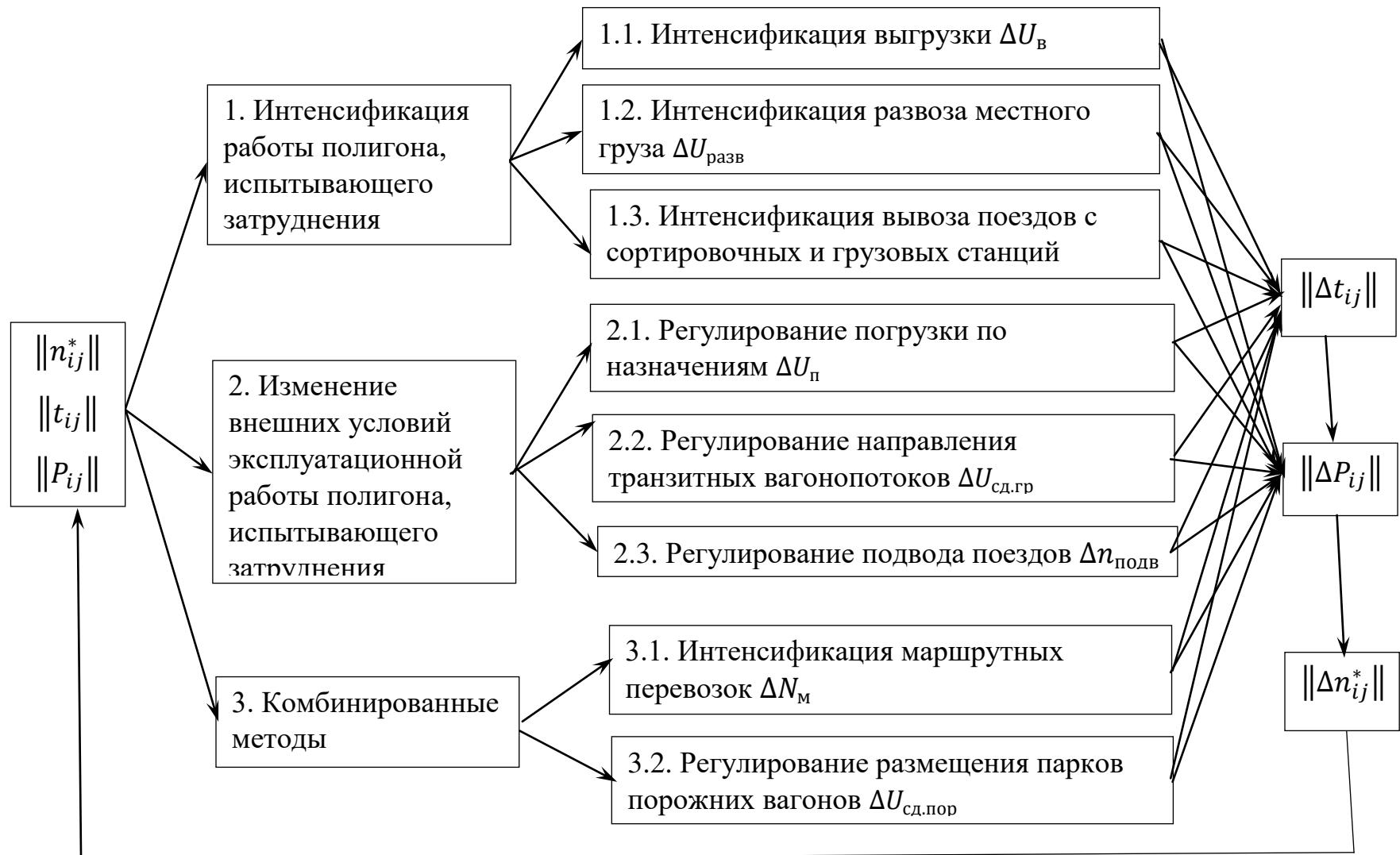
Рисунок 3.2 – Взаимозависимости параметров работы полигонов железнодорожной сети при устранении эксплуатационных затруднений
