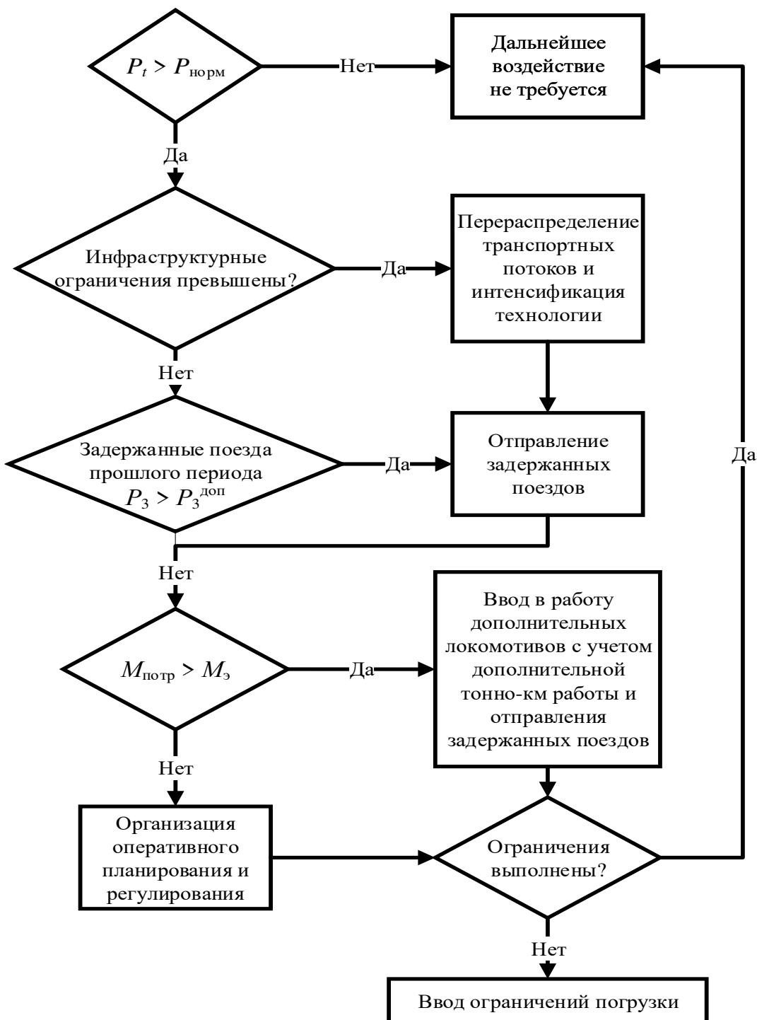
Рисунок 3.6 – Укрупненный алгоритм оценки соответствия балансового и нормативного наличия вагонов с выработкой управляющих воздействий
