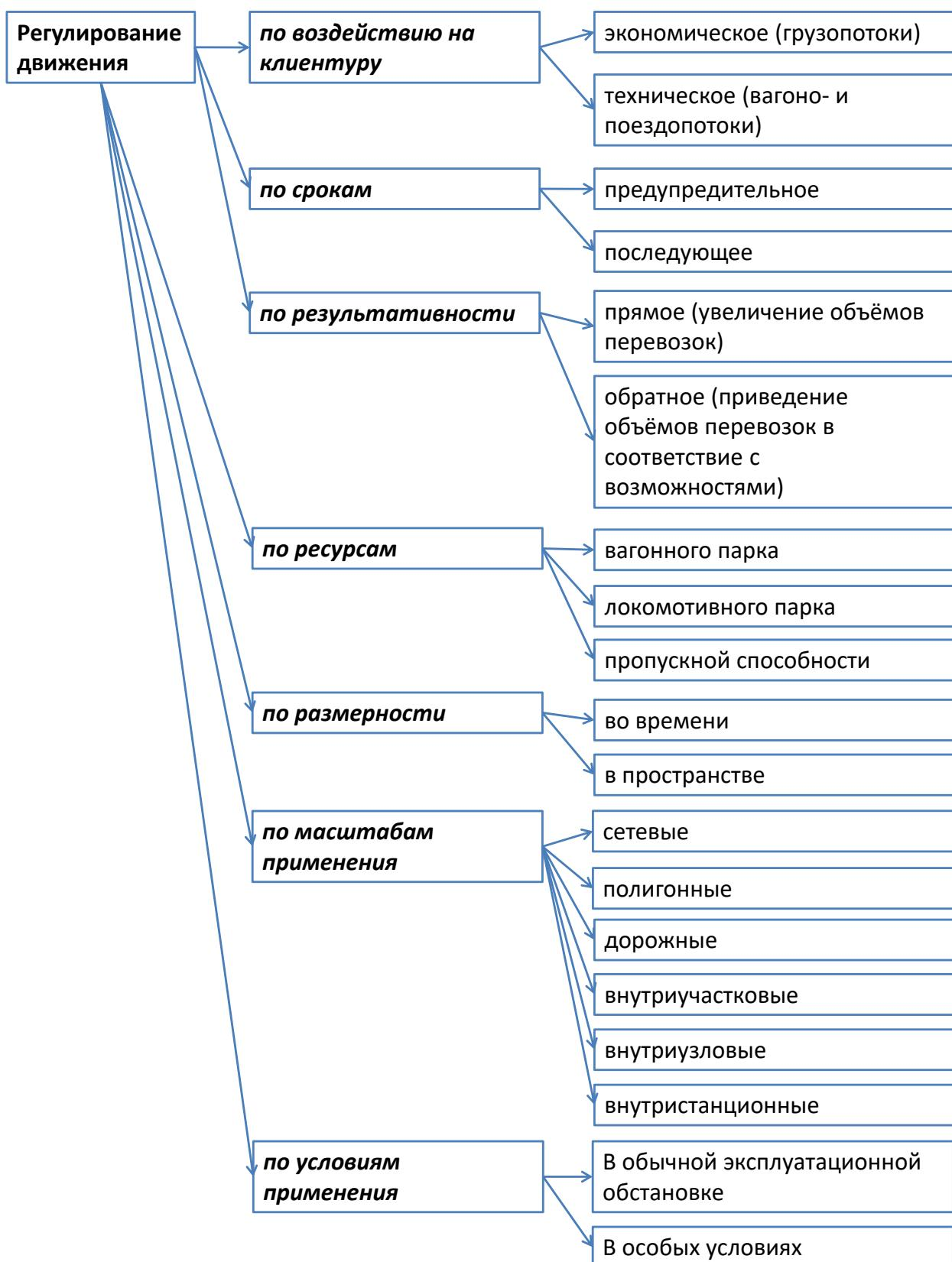
Рисунок 1.2 – Классификация методов регулирования движения
