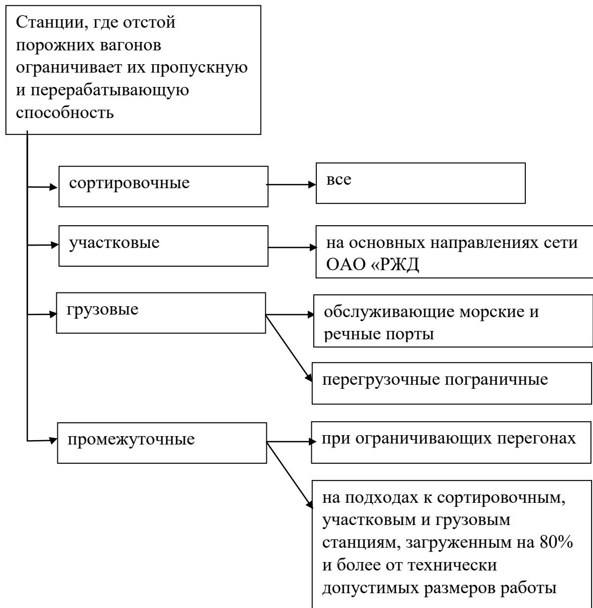
Рисунок 4.3 – Станции, где отстой порожних вагонов ограничивает их пропускную и перерабатывающую способность
