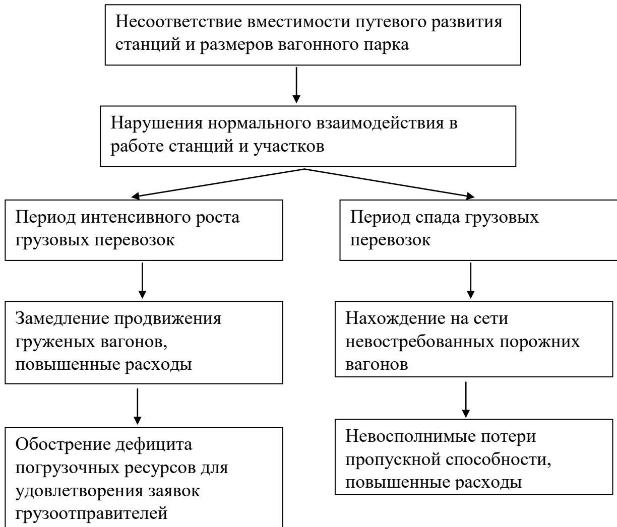
Рисунок 2.2 – Последствия несоответствия вместимости путевого развития станций и размеров вагонного парка в периоды роста и спада грузовых перевозок
