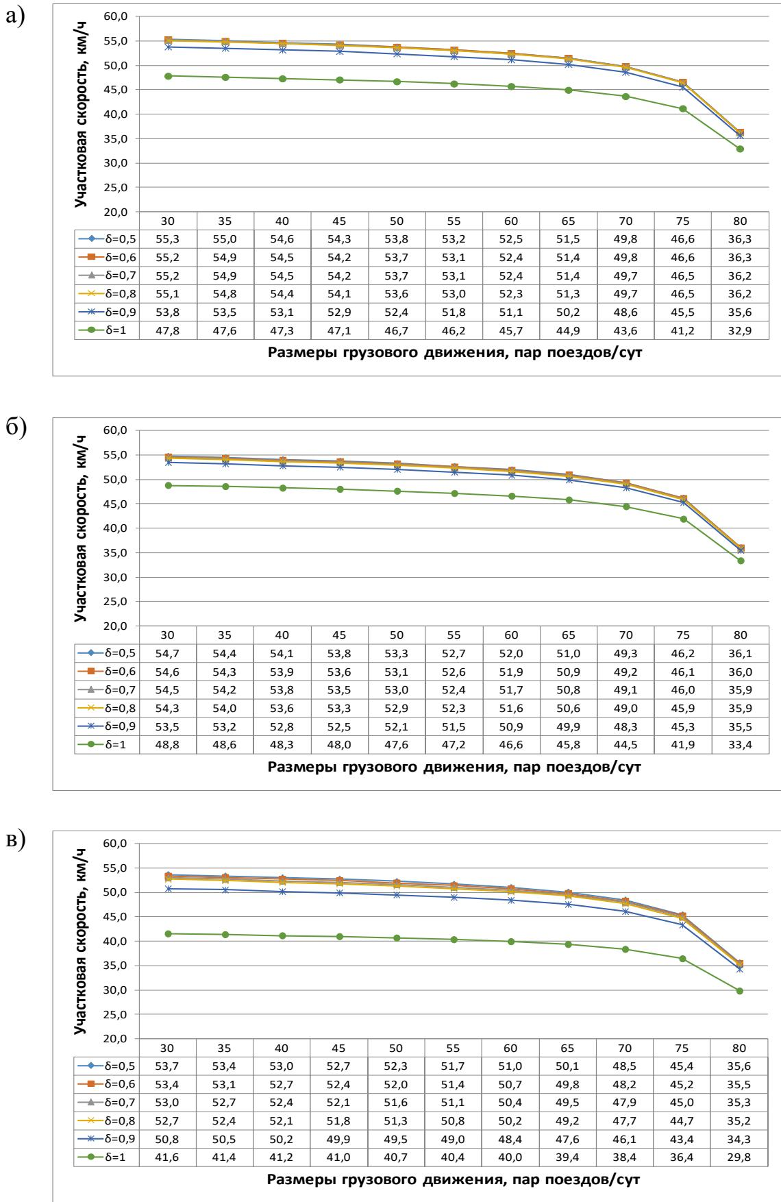
Рисунок 2.6 – Зависимость  $V_{\text{уч}} = f(n_{\text{гр}}, \delta)$  для двухпутного участка А – К: а) без учета враждебного элемента на подходе; б) с загрузкой враждебного элемента  $\gamma_{\text{вход}} = 0,2$ ; в) с загрузкой враждебного элемента  $\gamma_{\text{вход}} = 0,9$
