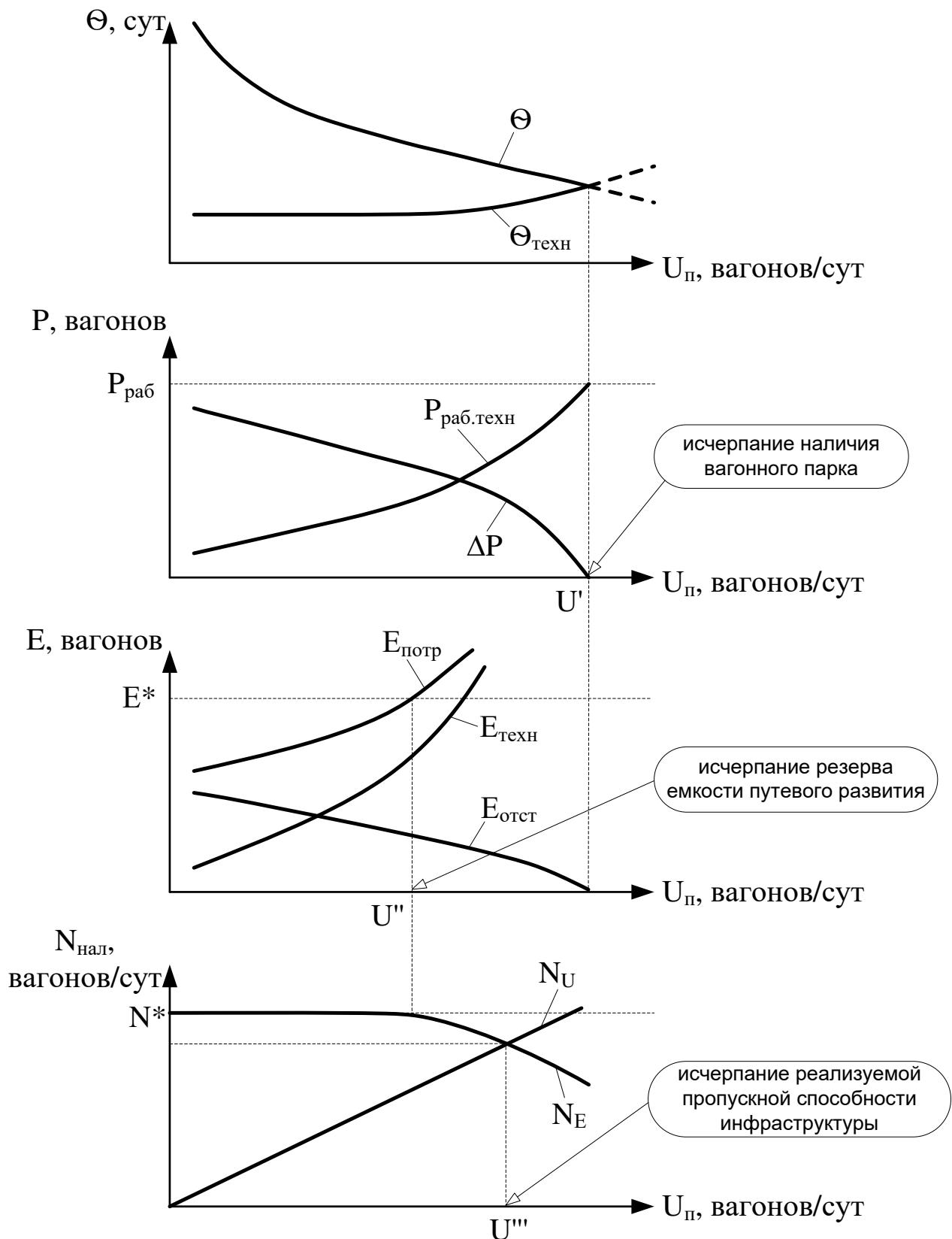
Рисунок А1 – Образование технологического дефицита вагонного парка
