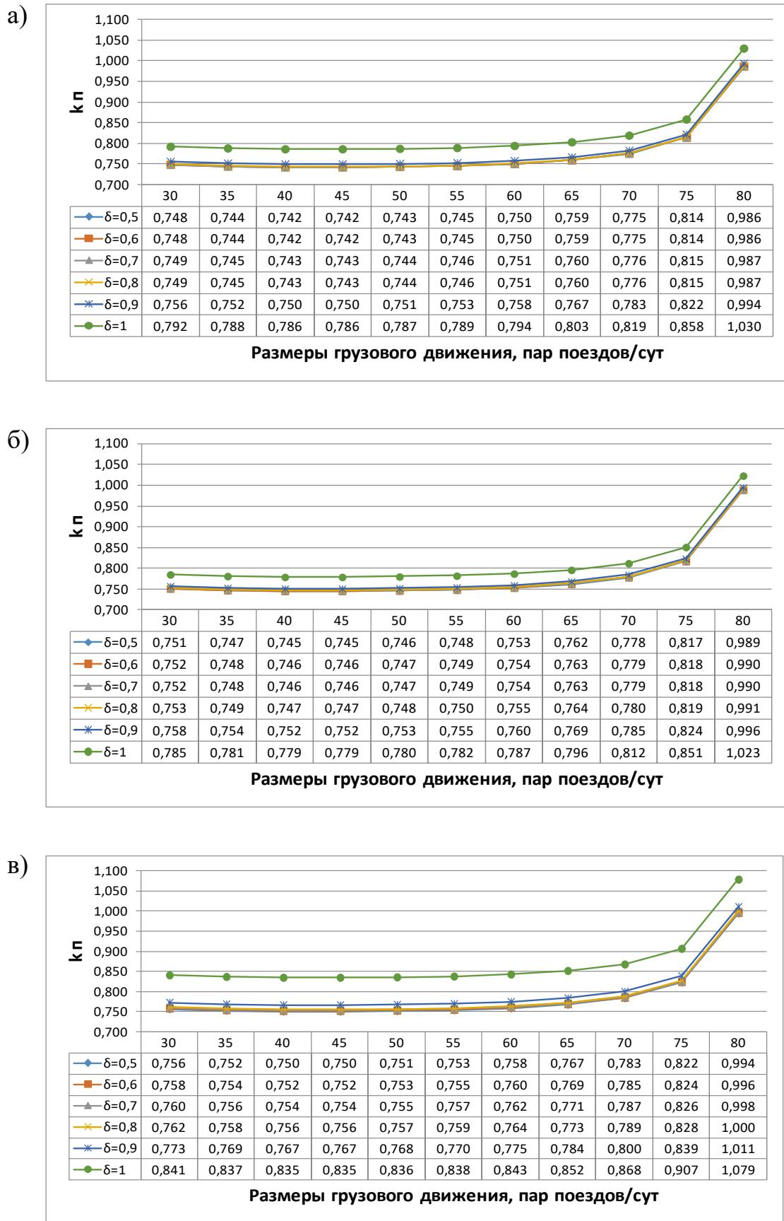
Рисунок 2.10 – Зависимость  $k_{\pi} = f(n_{\text{гр}}, \delta)$  для двухпутного участка А – К: а) без учета враждебного элемента на подходе; б) с загрузкой враждебного элемента  $\gamma_{\text{вход}} = 0,2$ ; в) с загрузкой враждебного элемента  $\gamma_{\text{вход}} = 0,9$
