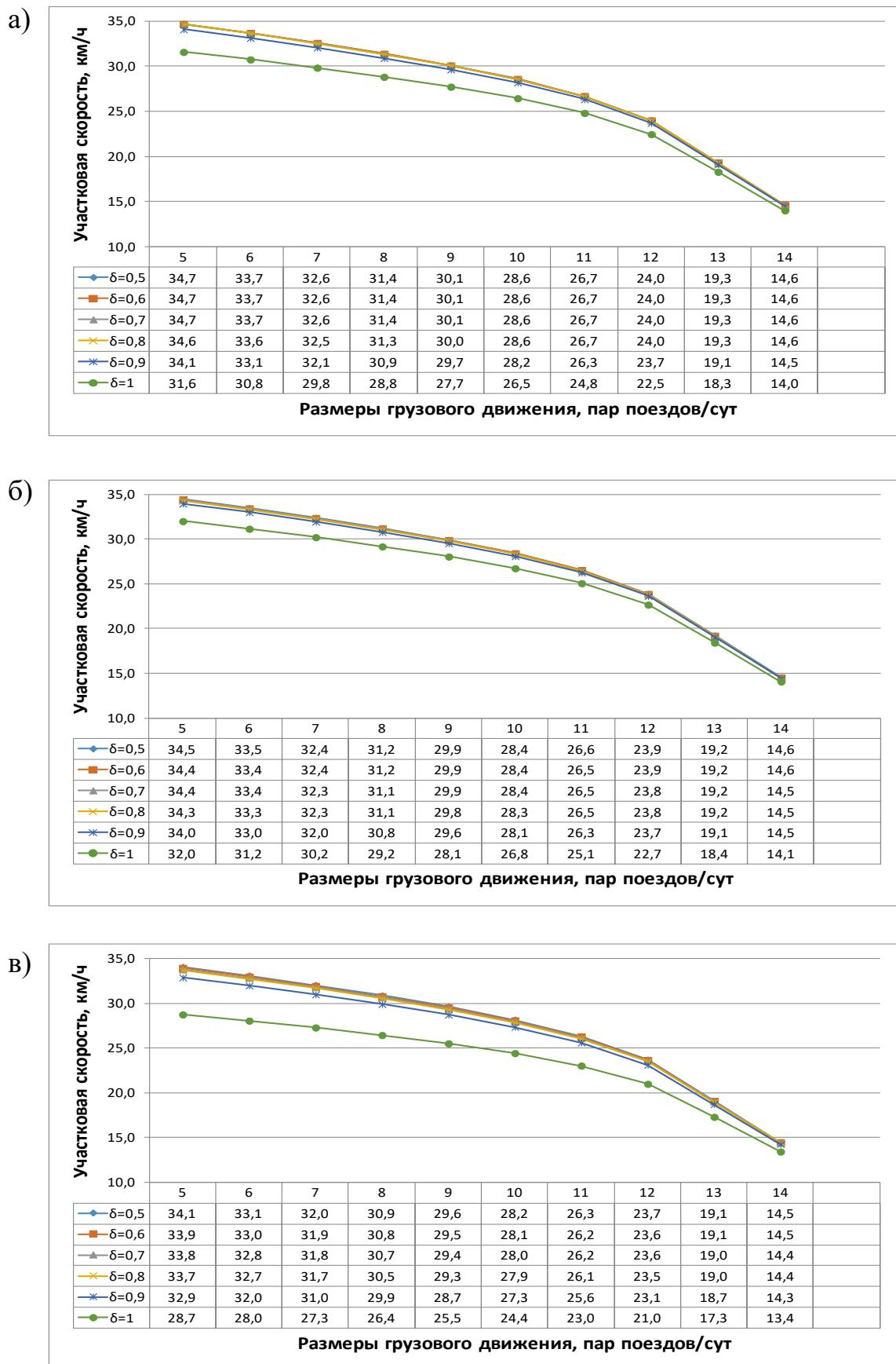
Рисунок 2.7 – Зависимость  $V_{\text{уч}} = f(n_{\text{гр}}, \delta)$  для однопутного участка А – Ч: а) без учета враждебного элемента на подходе; б) с загрузкой враждебного элемента  $\gamma_{\text{вход}} = 0,2$ ; в) с загрузкой враждебного элемента  $\gamma_{\text{вход}} = 0,9$
