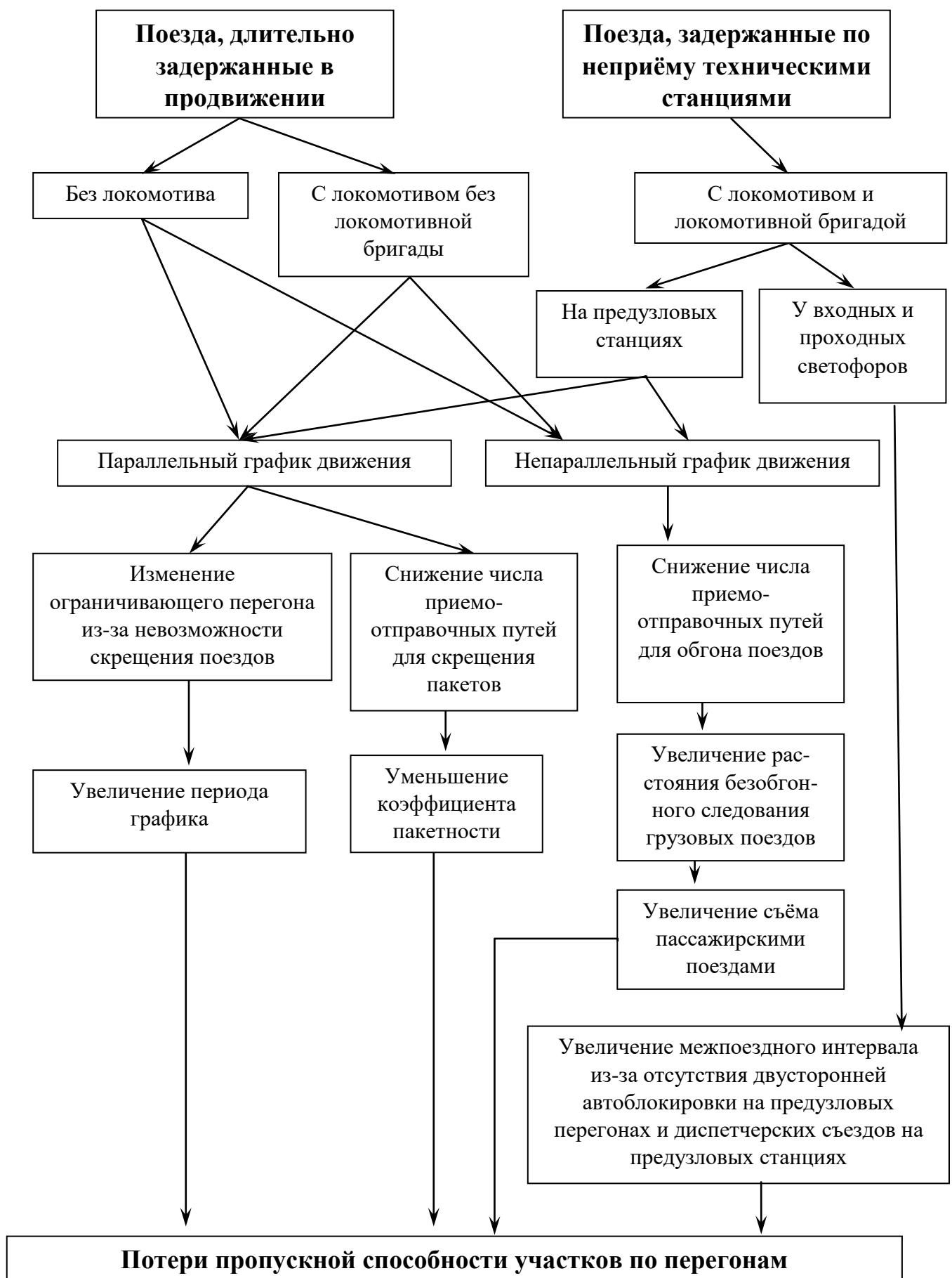
Рисунок 2.4 – Факторы, определяющие потери пропускной способности перегонов при избыточном насыщении участков поездами
