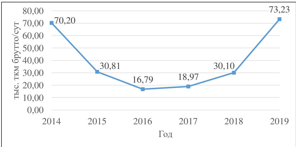
Рисунок 5.23 – Снижение производительности локомотива рабочего парка в грузовом движении поездов из-за избыточного парка грузовых вагонов на сети ОАО «РЖД» в 2014 – 2019 гг.
