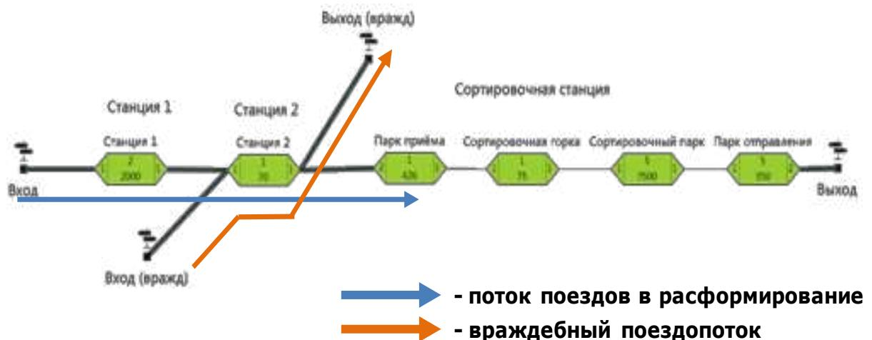
Рисунок 2.8 – Схема моделируемой транспортной сети для определения параметров взаимодействия технической станции и входного участка при задержках по неприёму поездов в исследовании [86]
