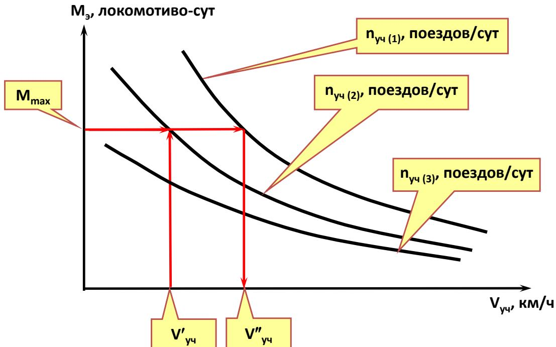
Рисунок 2.12 – Взаимосвязь участковой скорости, размеров грузового движения и эксплуатируемого парка локомотивов
