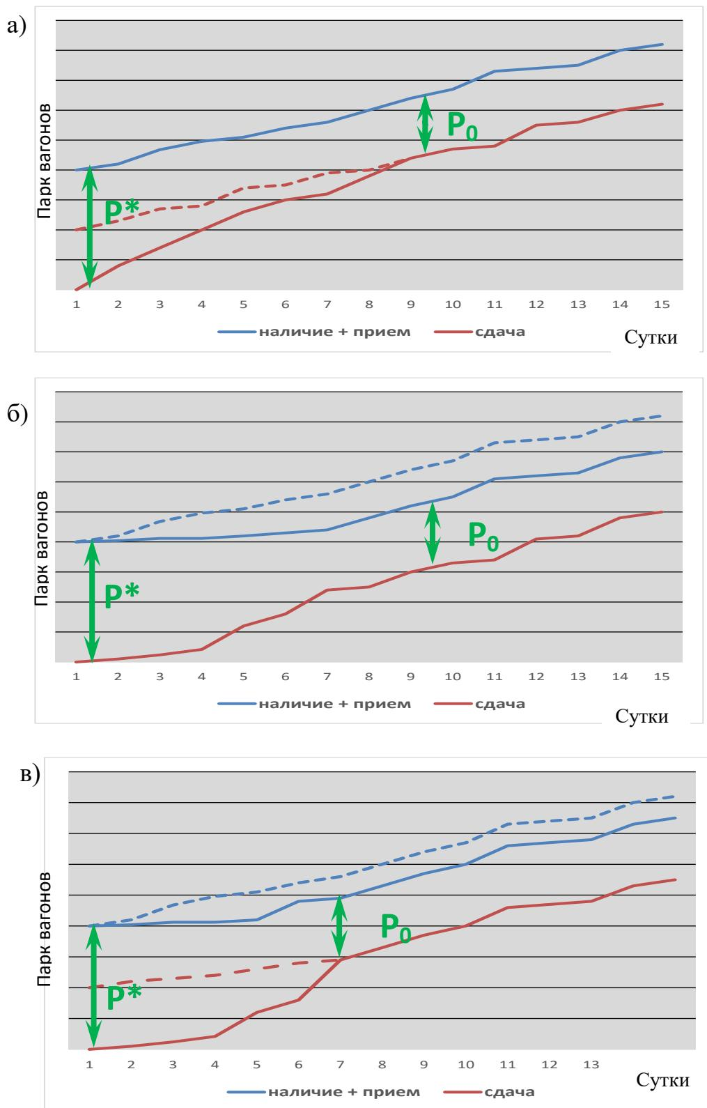
Рисунок 3.3 – Посуточная динамика рабочего парка вагонов на подразделении железнодорожной сети: а) устранение эксплуатационного затруднения за счет интенсификации работы подразделения, испытывающего трудности, и ускорения сдачи вагонов (повышения подвижности вагонопотока); б) устранение эксплуатационного затруднения за счет помощи других подразделений сети (ограничение приема вагонов); в) комбинированными методами
