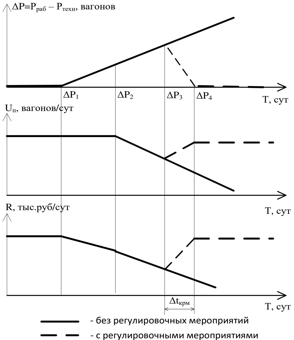
Рисунок 3.4 – Динамика превышения рабочего парка вагонов над технически допустимым  $\Delta P=P_{раб}-P_{техн}$ , погрузки  $U_n$  и финансового результата  $R$  при проведении регулировочных мероприятий и при их отсутствии
