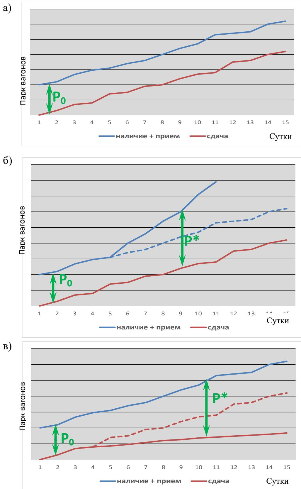
Рисунок 2.13 – Посуточная динамика рабочего парка вагонов на подразделении железнодорожной сети: а) нормальный режим эксплуатации; б) развитие эксплуатационного затруднения при сгущенном поступлении вагонов; в) развитие эксплуатационного затруднения при замедлении сдачи вагонов (снижении подвижности вагонопотока)
