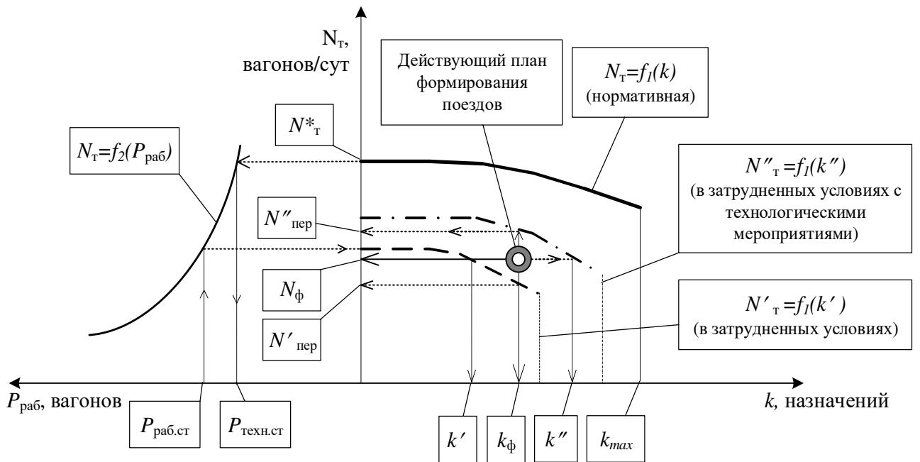
Рисунок 4.2 – Взаимосвязь технически допустимых размеров вагонопотока, поступающего в переработку, числа назначений формируемых поездов и рабочего парка вагонов
