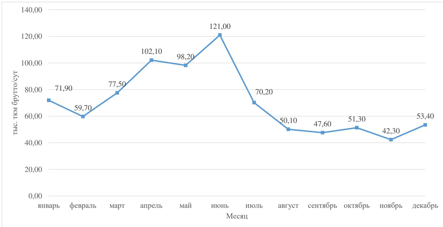
Рисунок 5.12 – Снижение производительности локомотива рабочего парка в грузовом движении из-за избыточного парка грузовых вагонов на сети ОАО «РЖД» в 2014 г.
