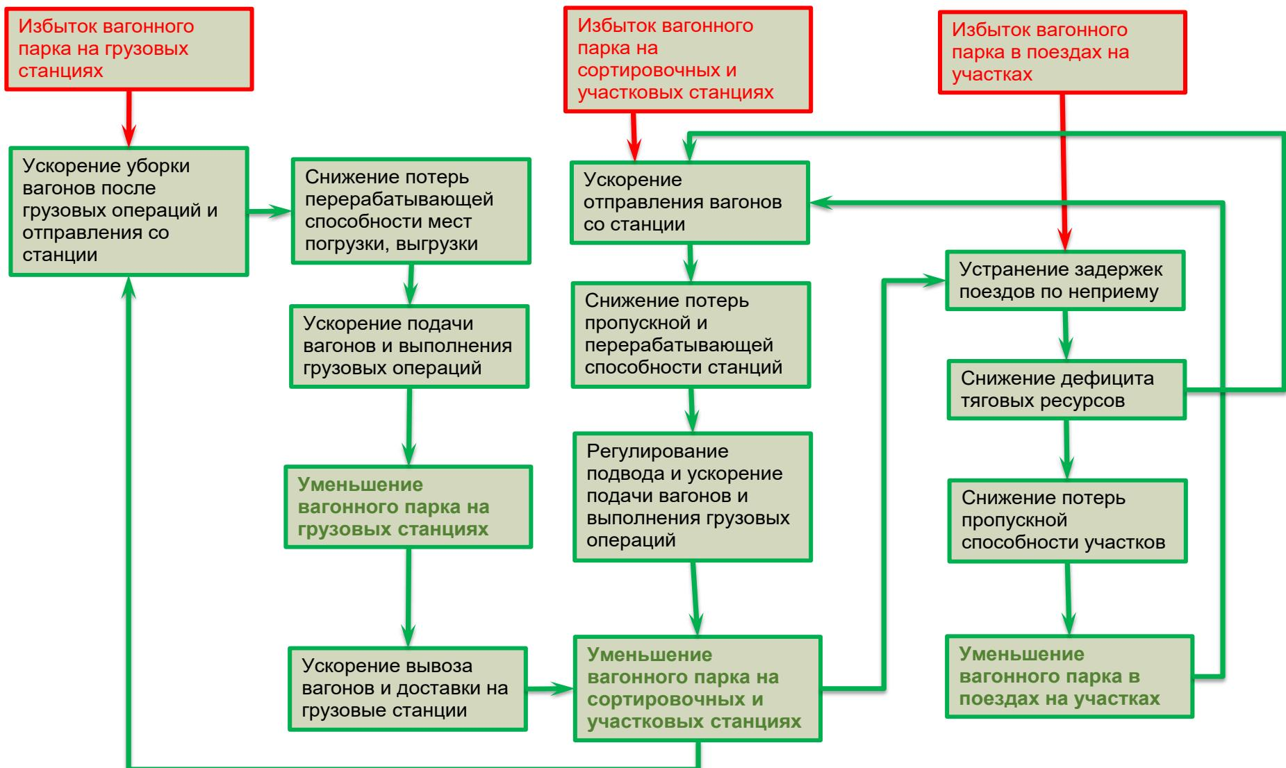
Рисунок 4.1 – Технологические взаимосвязи в процессах устранения эксплуатационных затруднений и восстановления рационального соотношения вместимости путевого развития и рабочего парка вагонов
