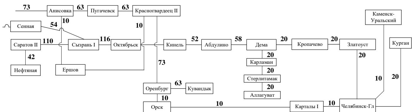
Рисунок 5.3 – Фрагменты схемы следования расчетных корреспонденций вагонопотоков до припортовых станций назначения
