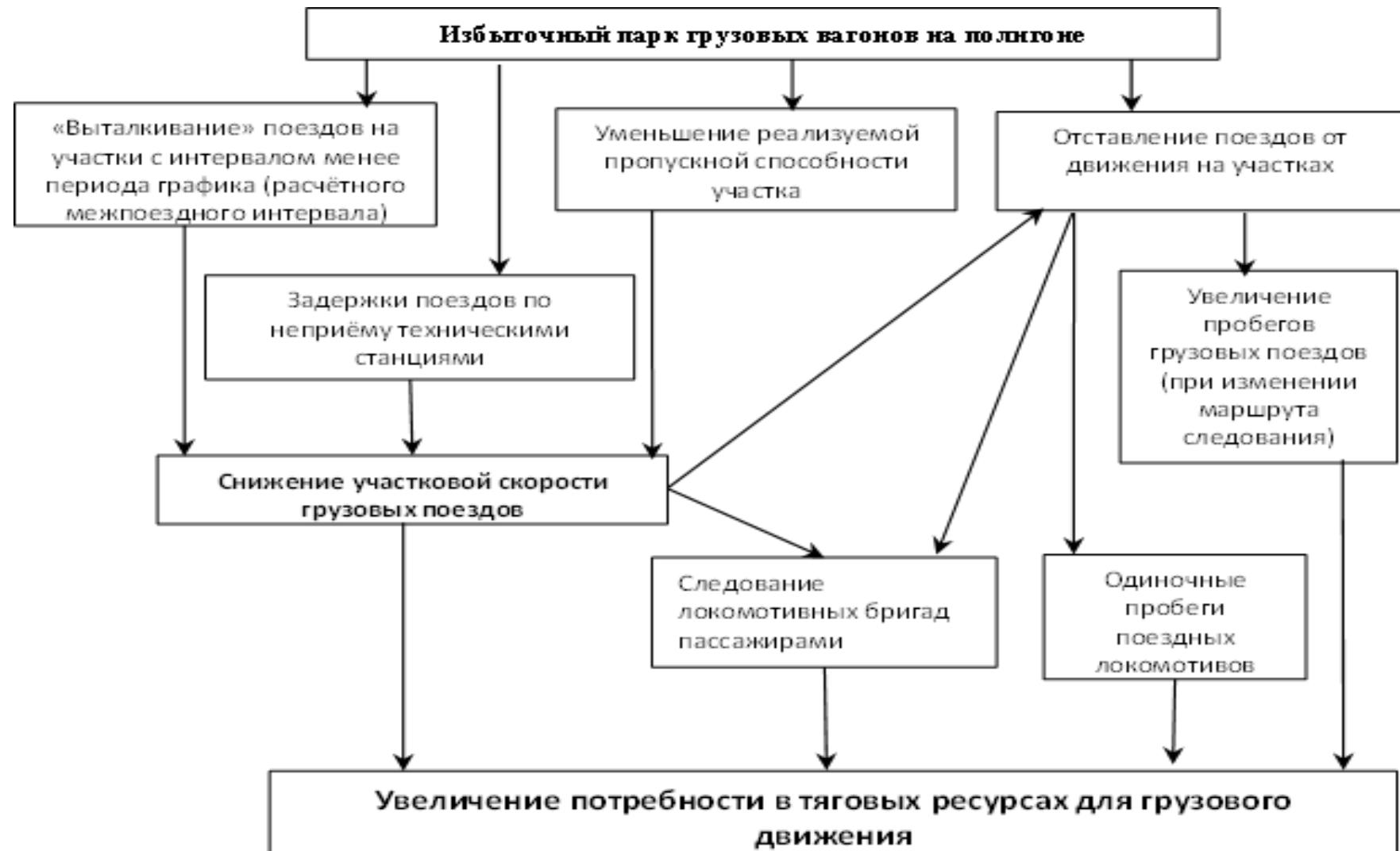
Рисунок 2.9 – Механизм действия факторов, вызывающих увеличение потребности в тяговых ресурсах для грузового движения в условиях избыточного парка грузовых вагонов
