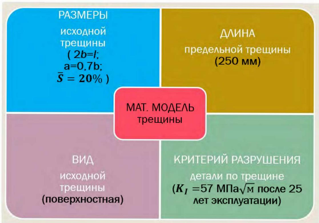
Рисунок 4.10 – Математическая модель развития усталостной трещины в литой детали тележки грузового вагона
