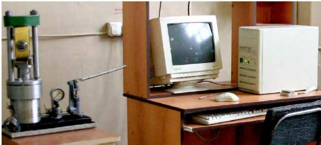
Рисунок 5.5 – Испытательный комплекс для квазистатических испытаний мини образцов при растяжении с построением полных диаграмм
