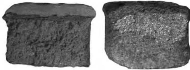
Рисунок 1.4 – Виды структуры сталей класса 20Л в состоянии поставки (слева – с преобладанием вязкой составляющей в изломе, справа – с преимущественно хрупкой составляющей в изломе), увеличение  $\times 3$
