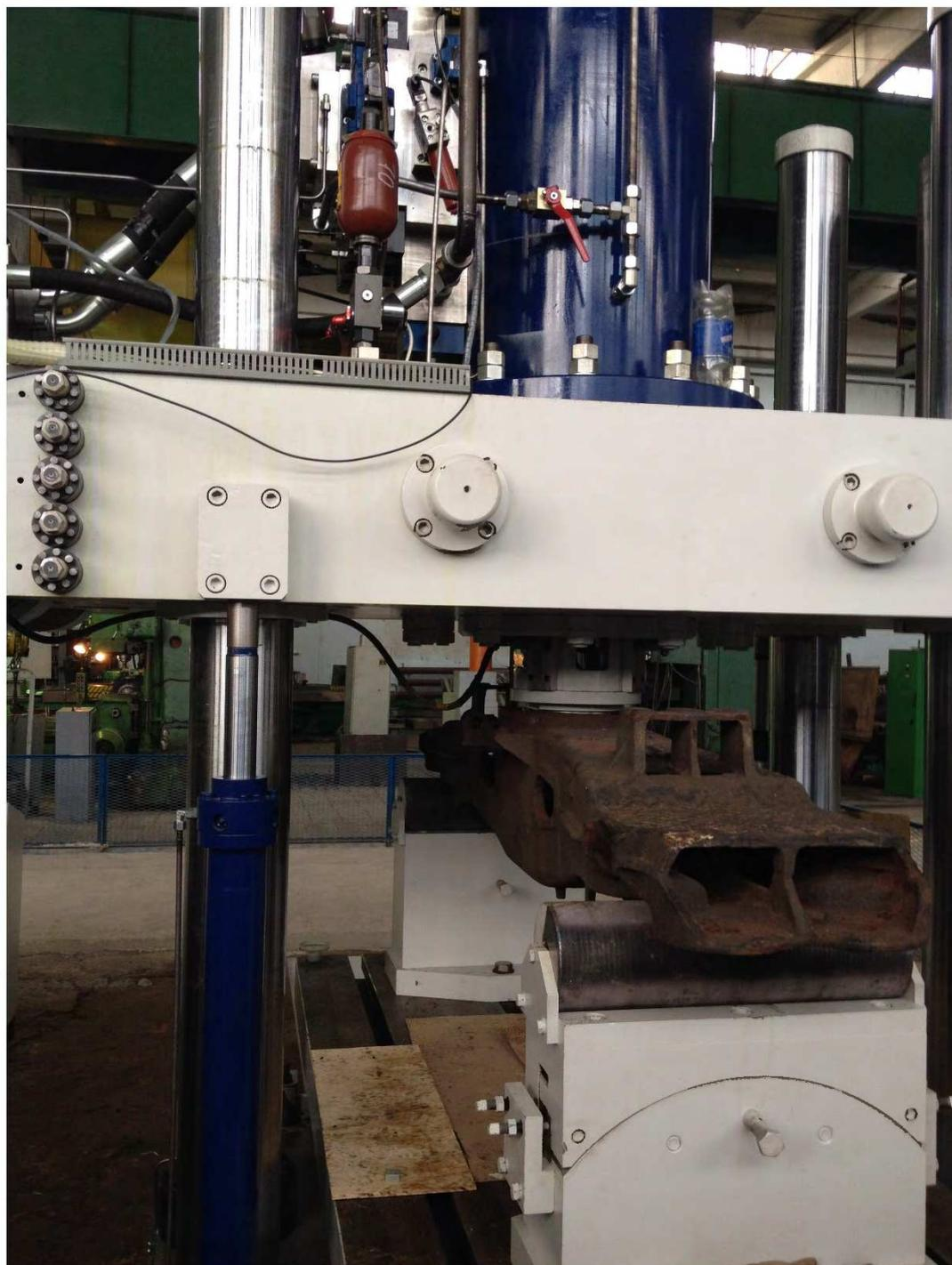
Рисунок 5.23 – Сервогидравлическая испытательная машина МДИ-2000 с установленной надрессорной балкой в рабочей зоне
