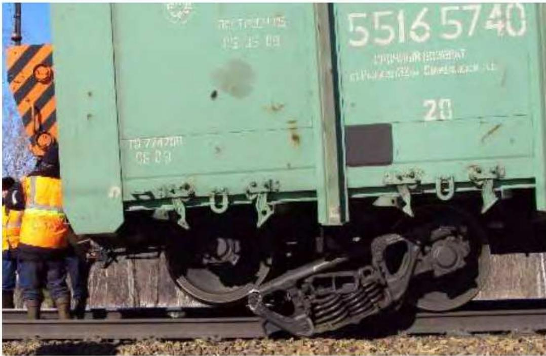
Рисунок 1.2 – Излом литой боковой рамы тележки полувагона
