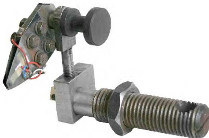
Рисунок 5.3 – Специальный экстензометр для измерения перемещений на рабочей части мини образцов
