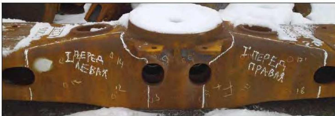
Рисунок 5.18 – Места вырезки темплетов из наддрессорной балки для изготовления прямоугольных образцов с центральным инициирующим надрезом
