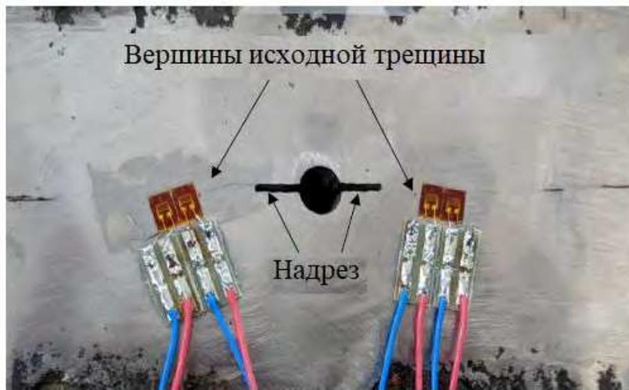
Рисунок 5.24 – Расположение тензорезисторов вблизи вершин выращенной исходной усталостной трещины длиной  $L_0$  по нижнему поясу надрессорной балки
