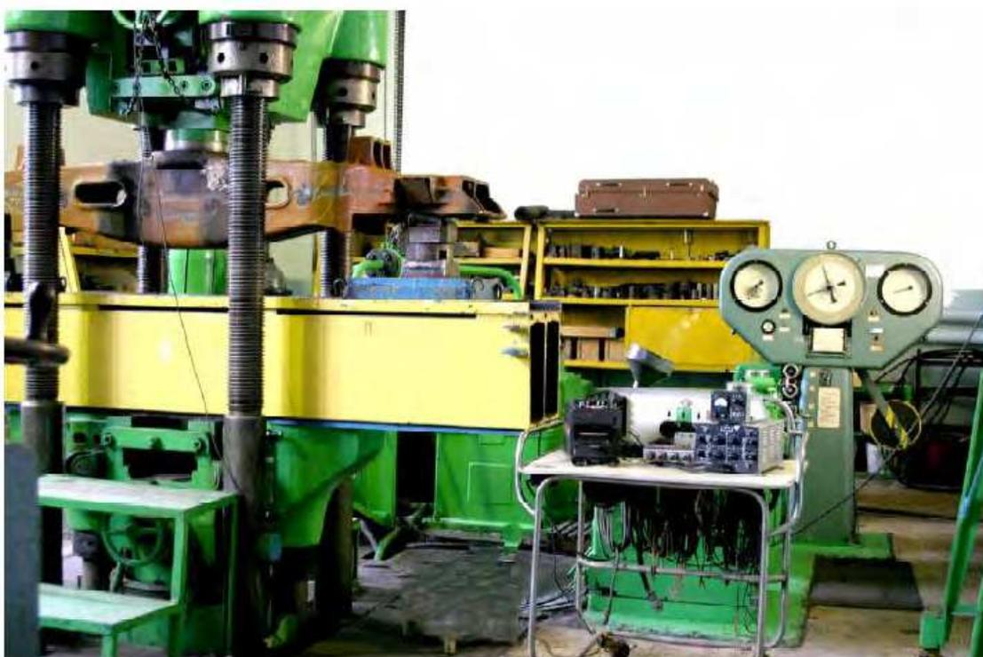
Рисунок 5.9 – Испытания на усталость литой надрессорной балки тележки грузового вагона на динамической испытательной машине ZDM-200
