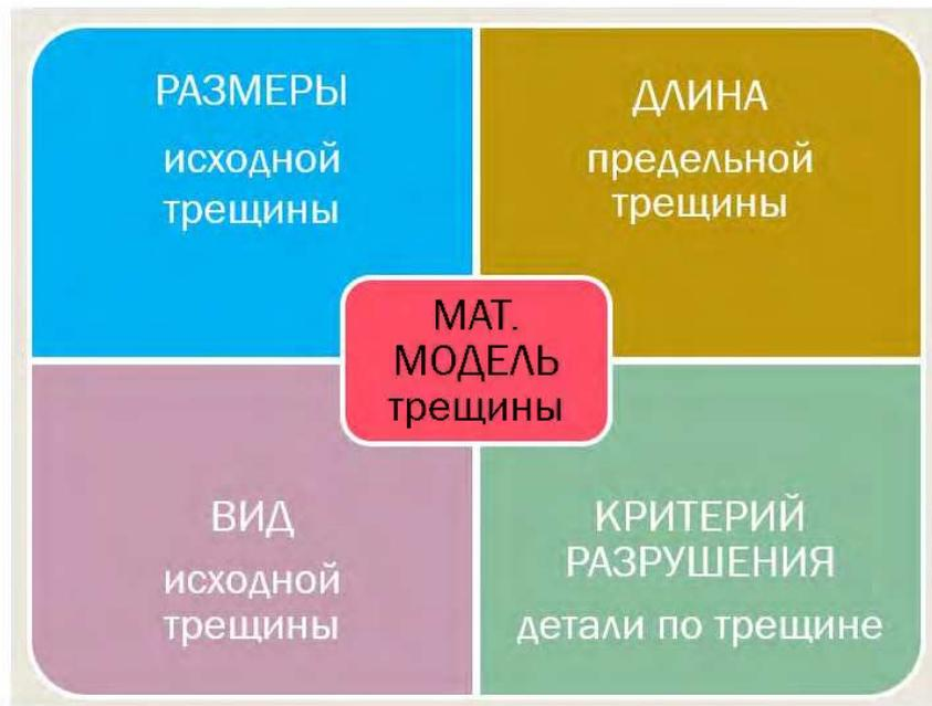
Рисунок 4.1 – Структурная схема математической модели развития усталостной трещины в литой детали тележки вагона
