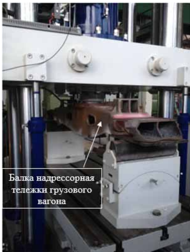
Рис.12. Испытания на усталость балки надressорной тележки грузового вагона на изобретенной испытательной машине
