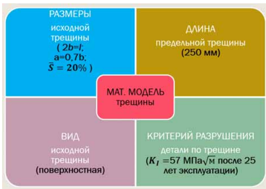
Рис.9. Математическая модель развития усталостной трещины в литой детали тележки грузового вагона
