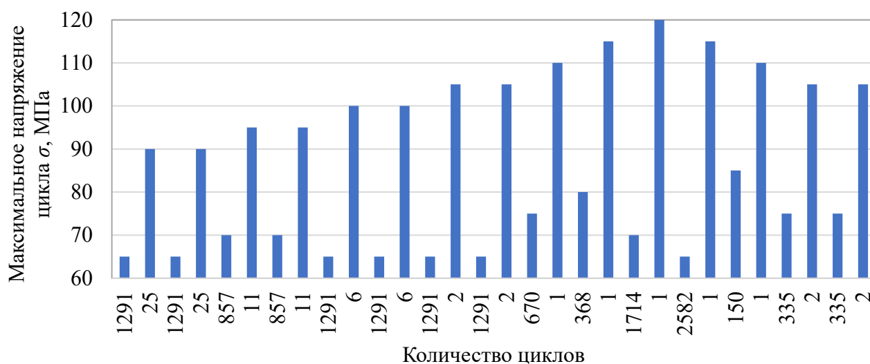
Рис.15. Блок максимальных напряжений циклов в буксовом проеме боковой рамы тележки 18-100 из тридцати переходов
