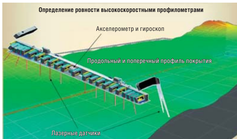
Рис. 2. Динамическая модель для определения ровности дорожного покрытия
