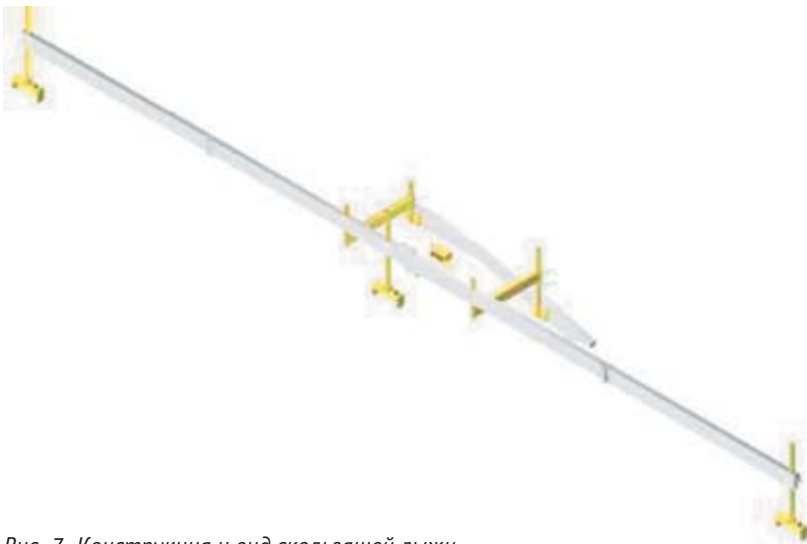
Рис. 7. Конструкция и вид скользящей лыжи, обеспечивающей контроль ровности микропрофиля
