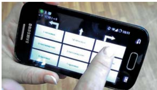
Рис. 2. Мобильное приложение Traffic counter на смартфоне с операционной системой Android
