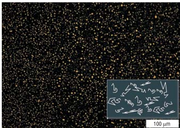
Рис. 6. Молекулярная структура конденсационных полисопряженных связей асфальтовяжущего — полимера-резины
