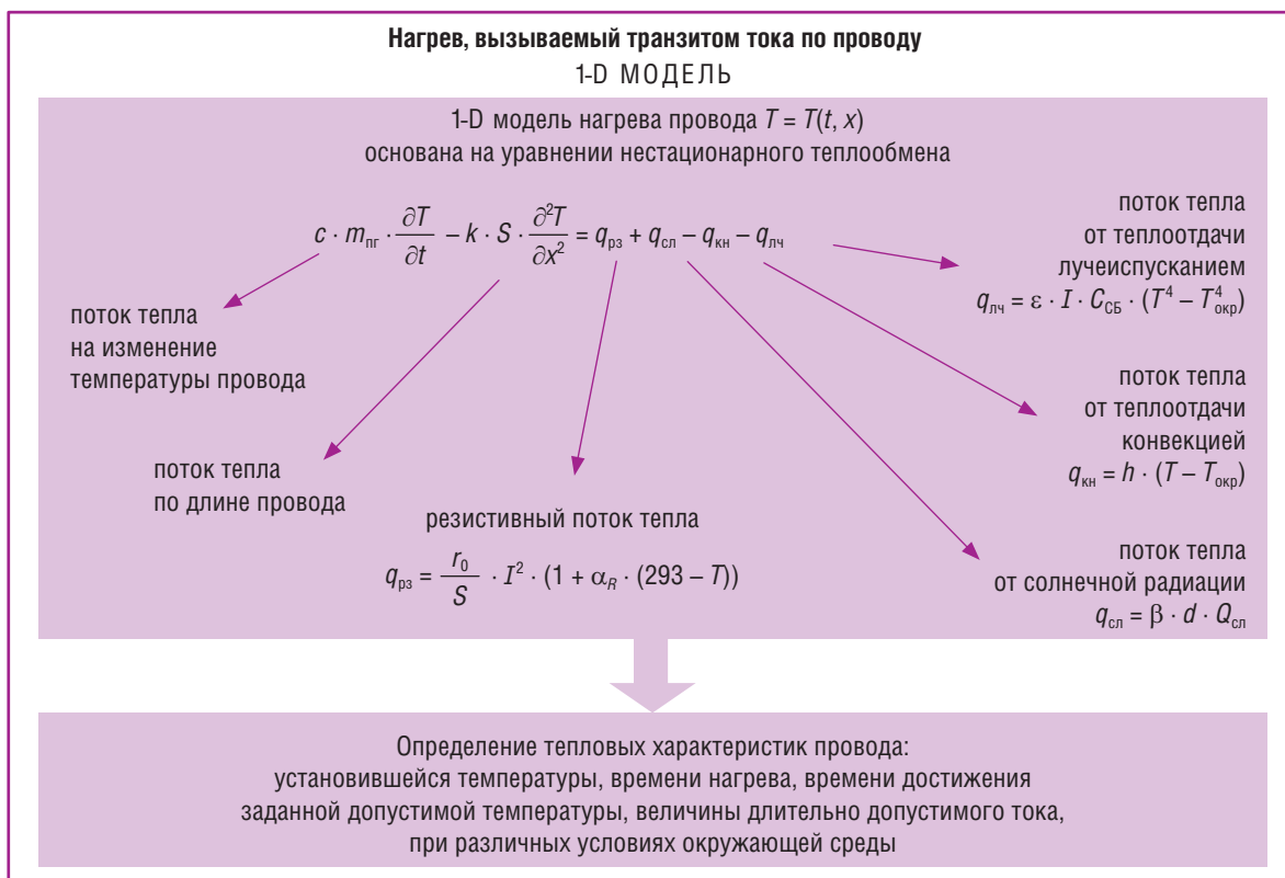
Рис. 1. Математическая модель нагрева провода в случае транзита тягового тока по проводу
