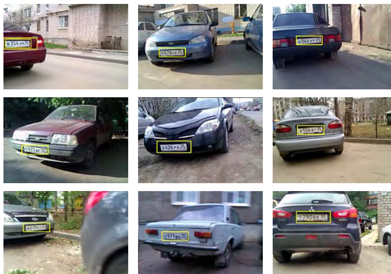
Рис. 2. Автомобильные номера, обнаруженные каскадом Хаара
