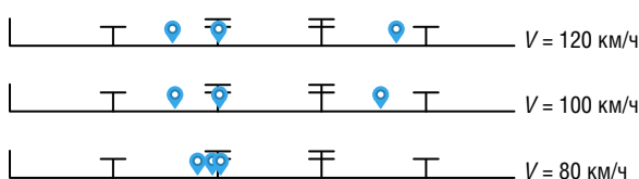
Рис. 1. Место максимальных поперечных сил при шаге моделирования 25 см в зависимости от скорости движения
