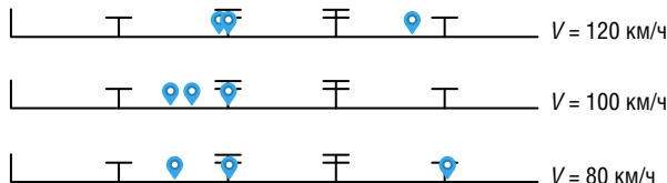
Рис. 2. Место максимальных поперечных сил при шаге моделирования 1 см в зависимости от скорости движения
