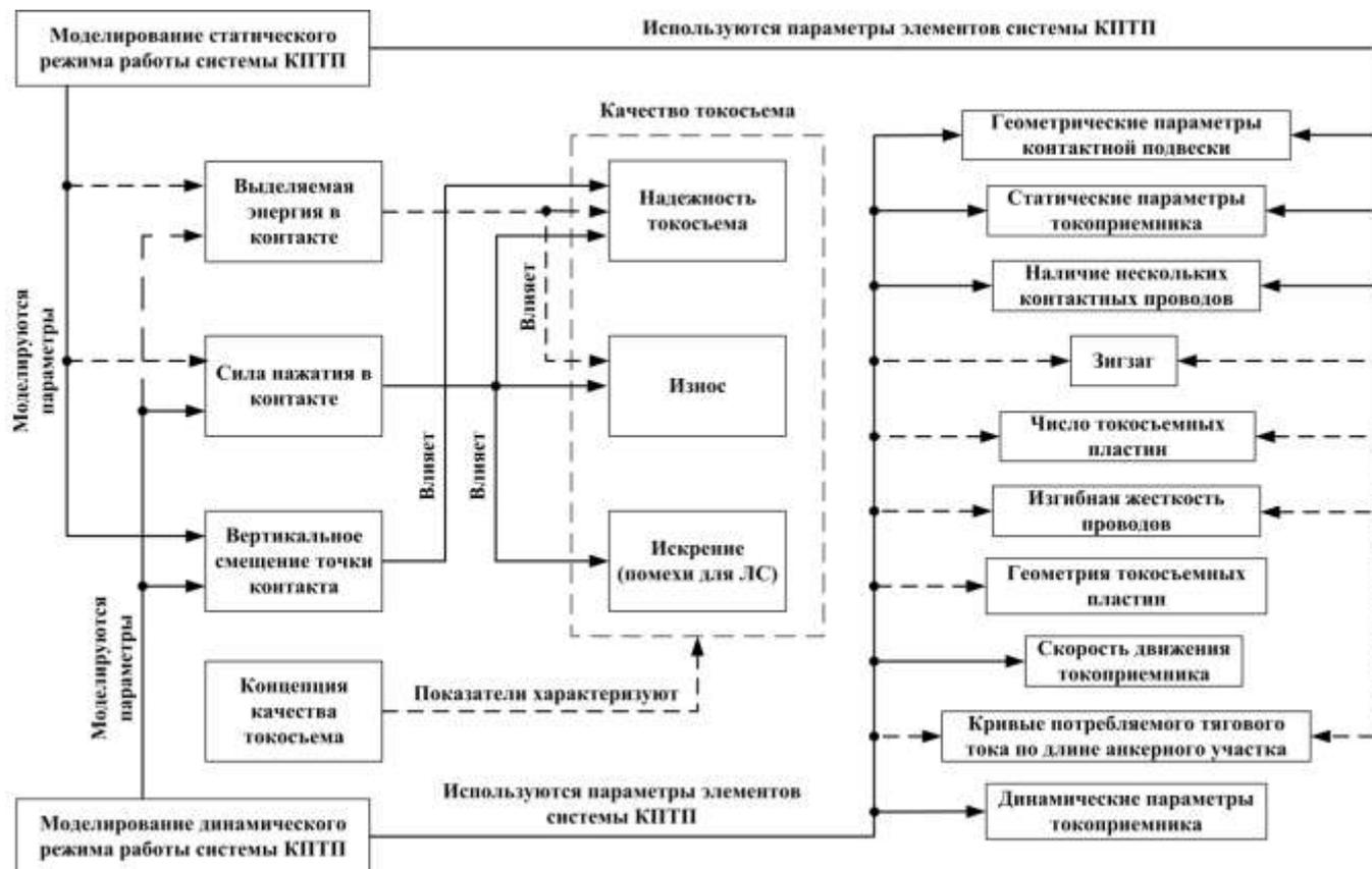
Рисунок 1 – Параметры, учитываемые при моделировании взаимодействия контактного провода и токоприемника в статическом и динамическом режимах
