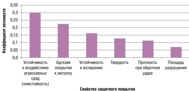
Рис. 2. Диаграмма весомости свойств защитных покрытий (перед испытаниями)
