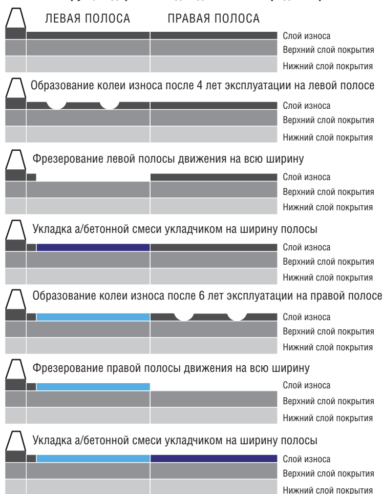
Рис. 6. Предлагаемая схема замены верхних слоев автомобильных дорог с высокими эксплуатационными требованиями
