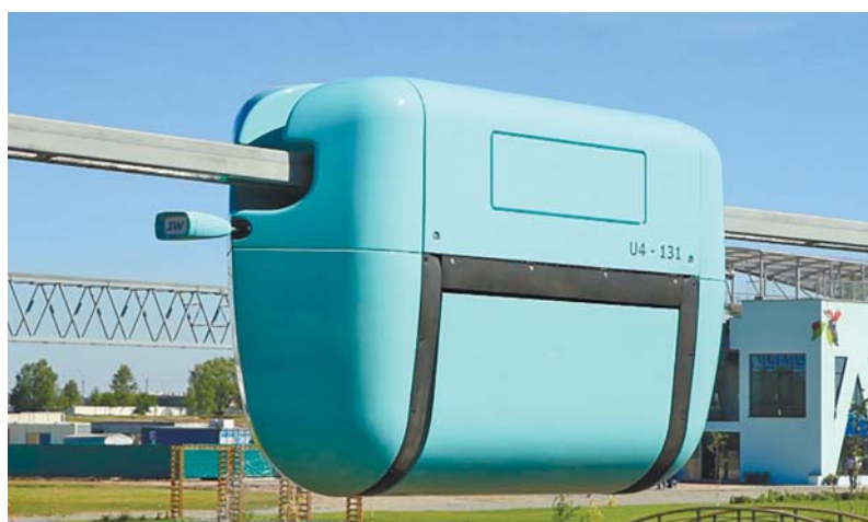
Рис. 2. Грузовое транспортное средство — подвесной юнитрак. «ЭкоТехноПарк», 2018 г.
