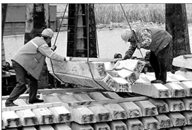
После обработки электрическим полем вяжущих компонентов бетонные изделия стали прочнее примерно на треть
