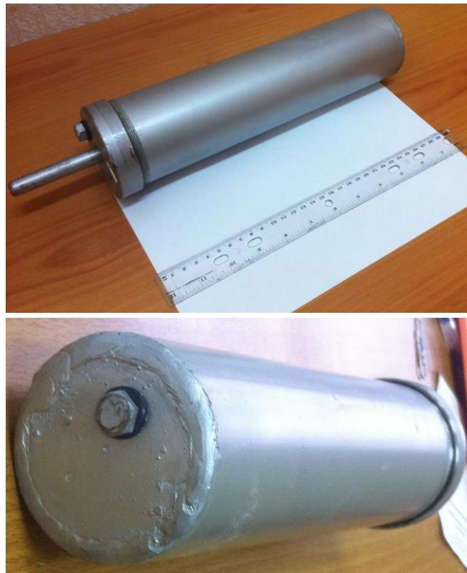
Рисунок 2.14 – Рабочий образец жидкостно-газового компенсатора ПЖГ-1
