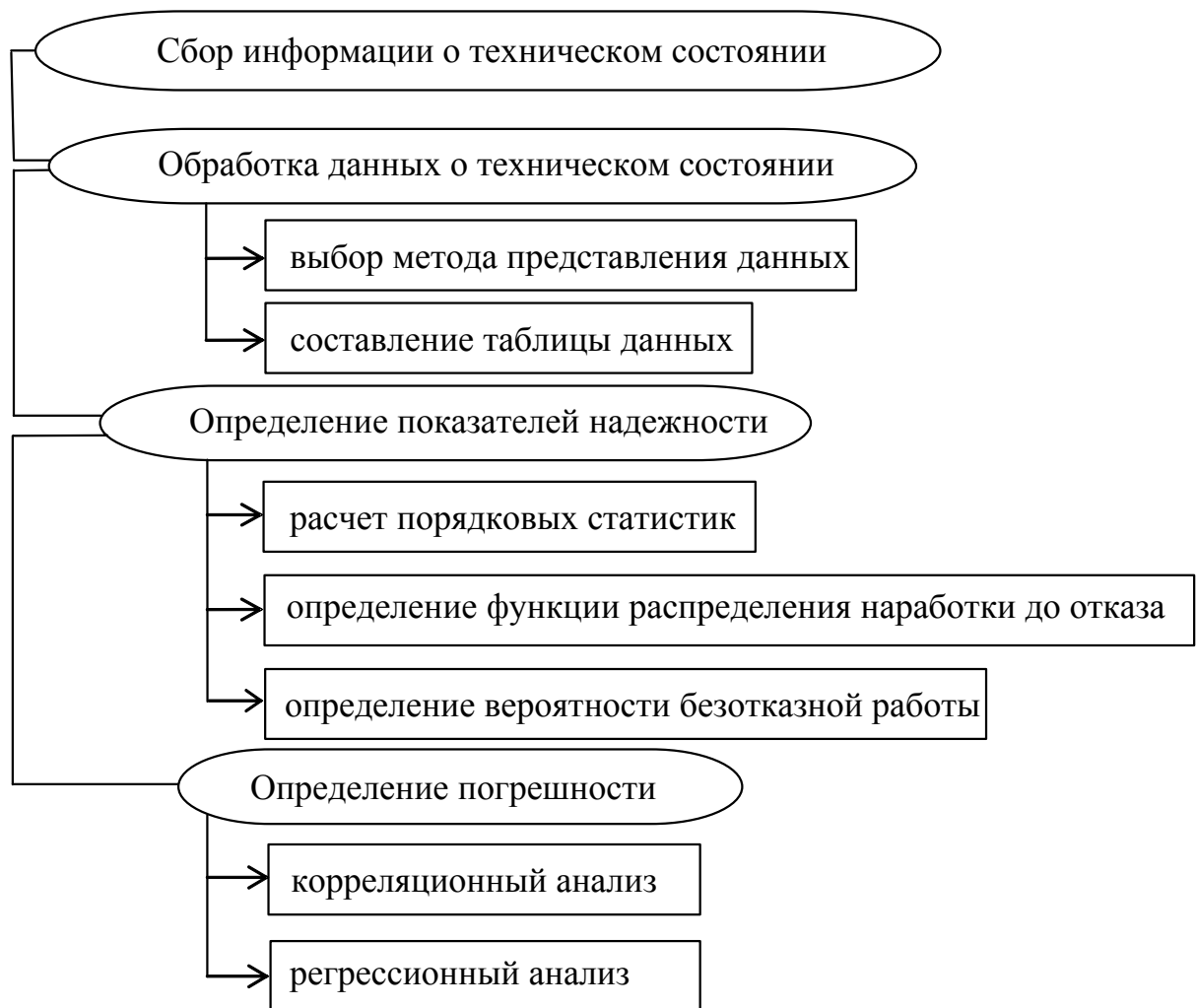
Рис. 1 – Методика прогнозирования надежности трамвайного вагона по данным об отказах в эксплуатации
