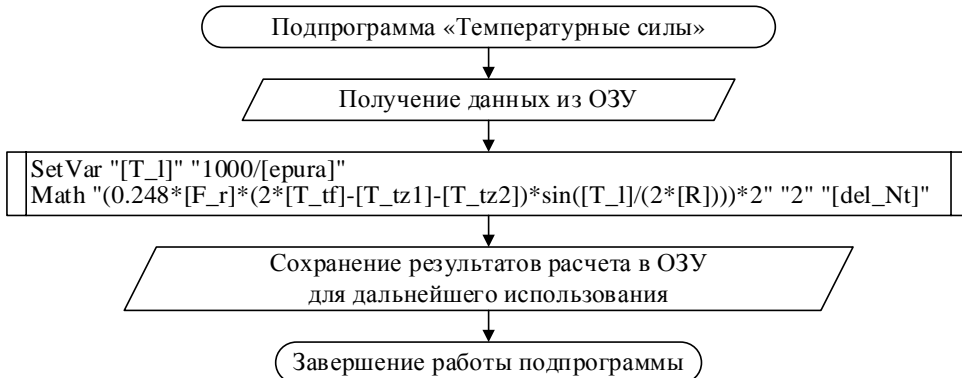
Рис. 5. Блок-схема подпрограммы «Расчет температурных сил»
