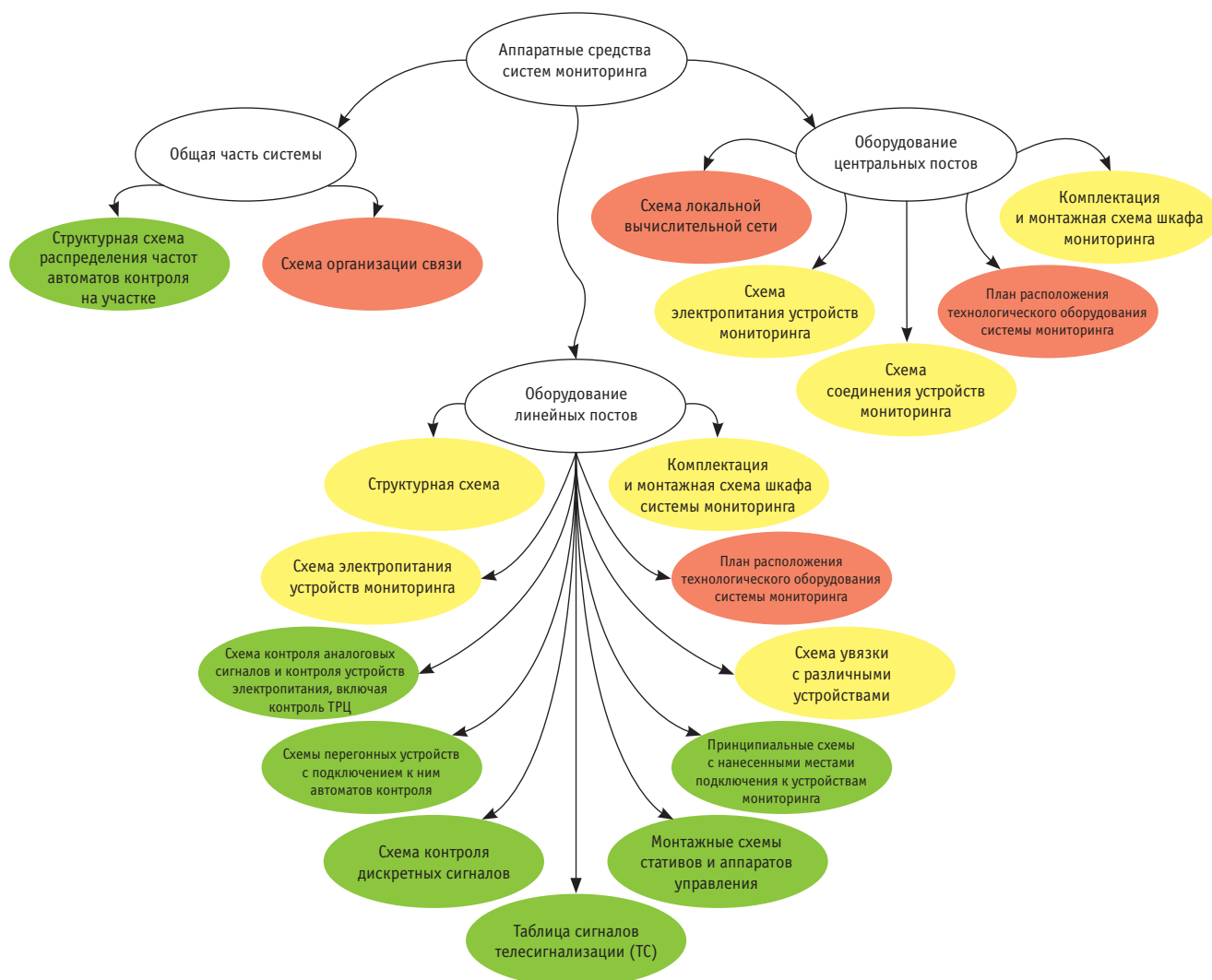
Рис. 1. Структура проектирования аппаратных средств мониторинга устройств ЖАТ
