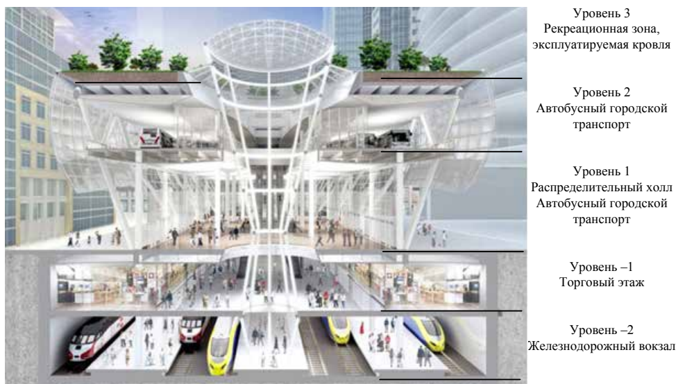
Рис. 5. Разрез транзитного центра «Трансбэй», Сан-Франциско, США [19]
