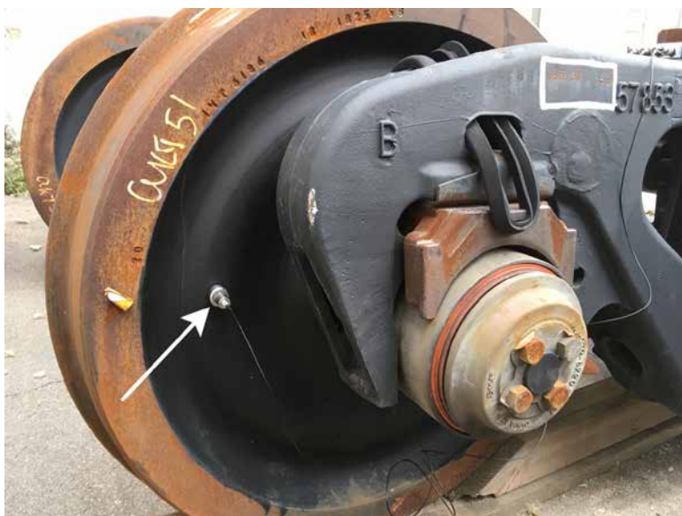
Рис. 1. Установка акселерометра на диске колеса
