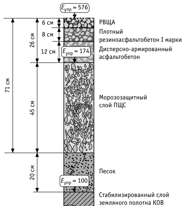
Рис. 4. Пример нежесткой конструкции строения пути для ВСМ
