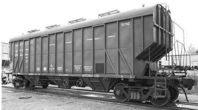
Рис. 7. Вагон-хopper с осевой нагрузкой 27 тс для перевозки зерна (модель 19-6952)
