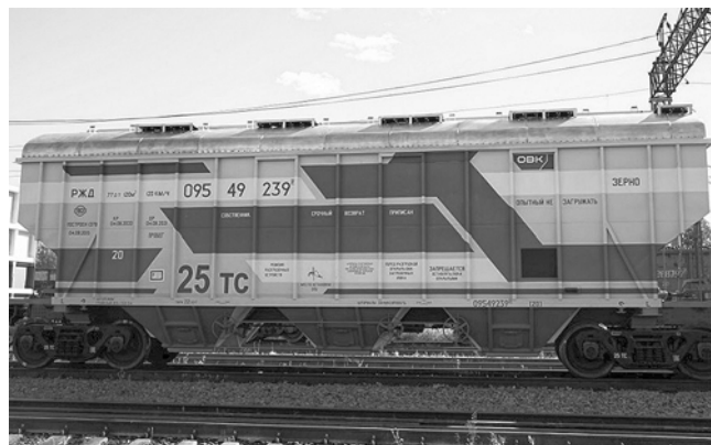
Рис. 6. Вагон-хopper с крышей из алюминиевого сплава для перевозки зерна (модель 19-9549-02)
