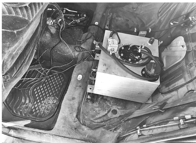
Рис. 2. Экспериментальная установка для измерения расхода топлива (установлена в автомобиле на месте заднего сиденья)
