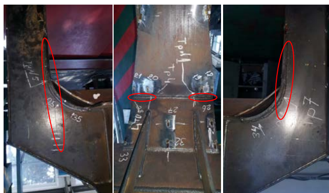
Рис. 6. Общий вид трещин в образце узла заделки стойки
