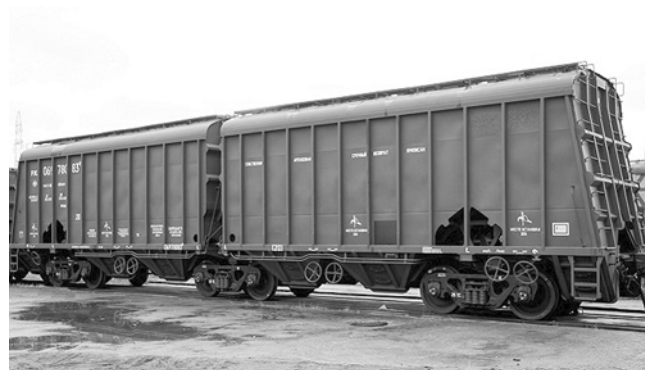
Рис. 8. Шестиосный вагон-хopper сочлененного типа для перевозки зерна (модель 19-6978)
