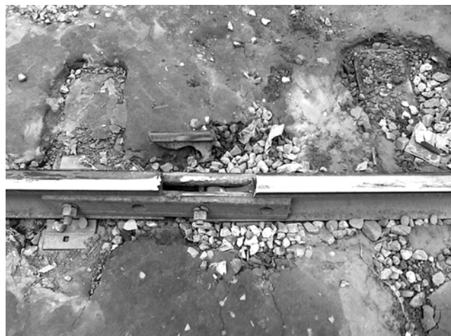
Рис. 4. Излом рельса на перегоне Красная Речка — Корфовская [3]
