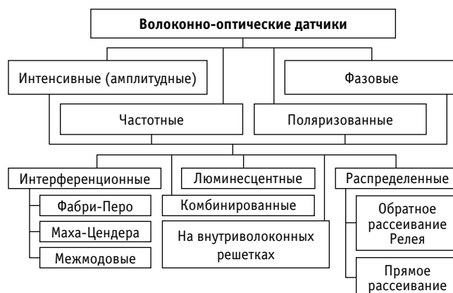
Рис. 3. Классификация волоконно-оптических датчиков
