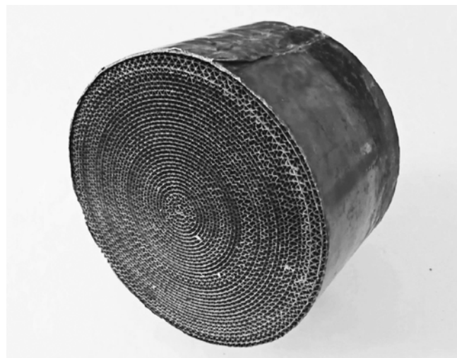
Рис. 3. Сотовый блок после испытаний на стенде
