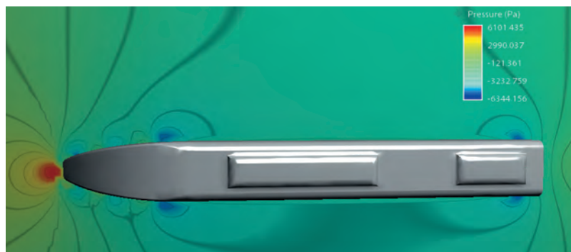
Рис. 5. Распределение зон давления воздушного потока (вид сверху)
