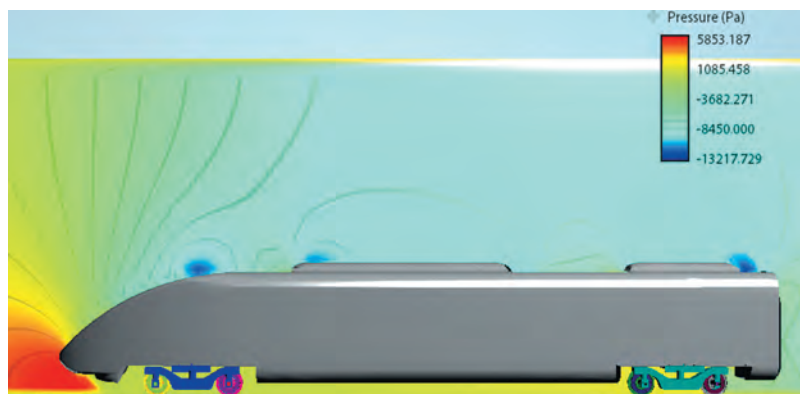
Рис. 4. Распределение зон давления воздушного потока (вид сбоку)
