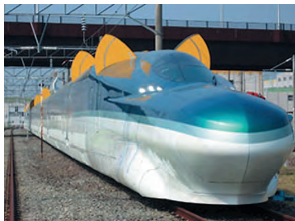
Рис. 1. Высокоскоростной электропоезд с аэродинамическим тормозом
