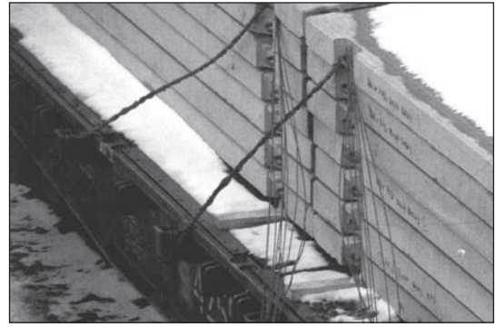
Рис. 3. Ослабление растяжек от сдвига штабельных грузов поперек вагона
