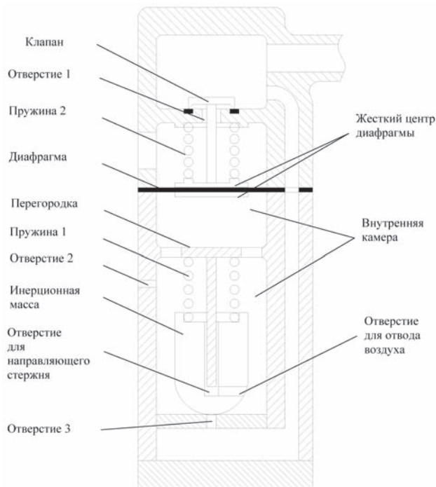
Рис. 1. Эскиз устройства регистрации схода
