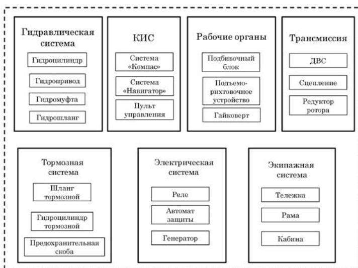
Рис. 5. Схема основных узлов путевой машины
