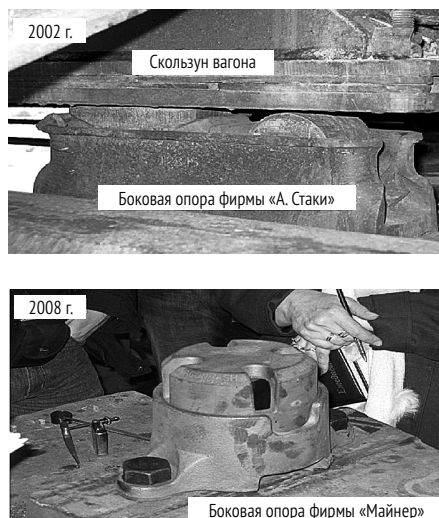
Рис. 1. Конструкции боковых опор
