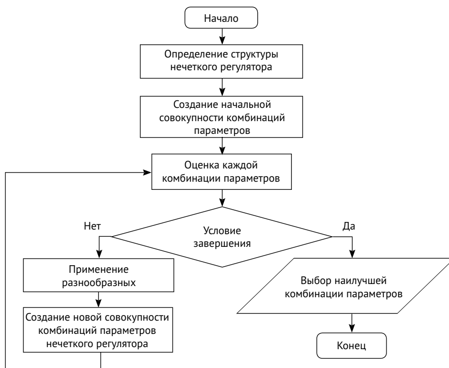
Рис. 3. Схема построения нечеткого регулятора
