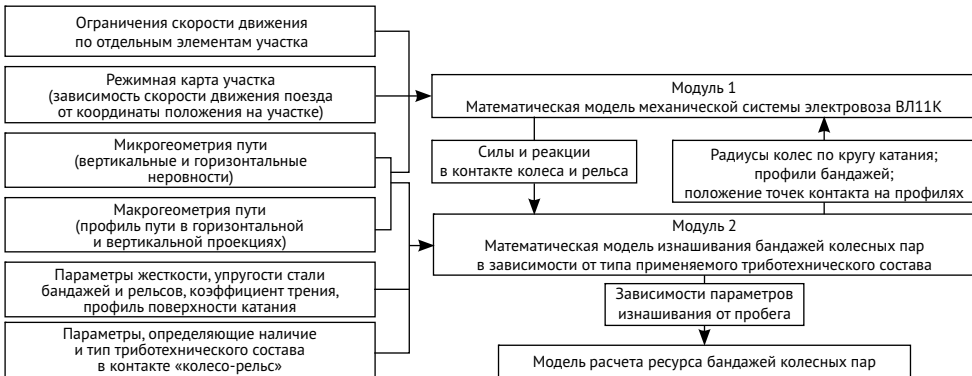
Рис. 2. Блок-схема комплексной модели изнашивания бандажей
