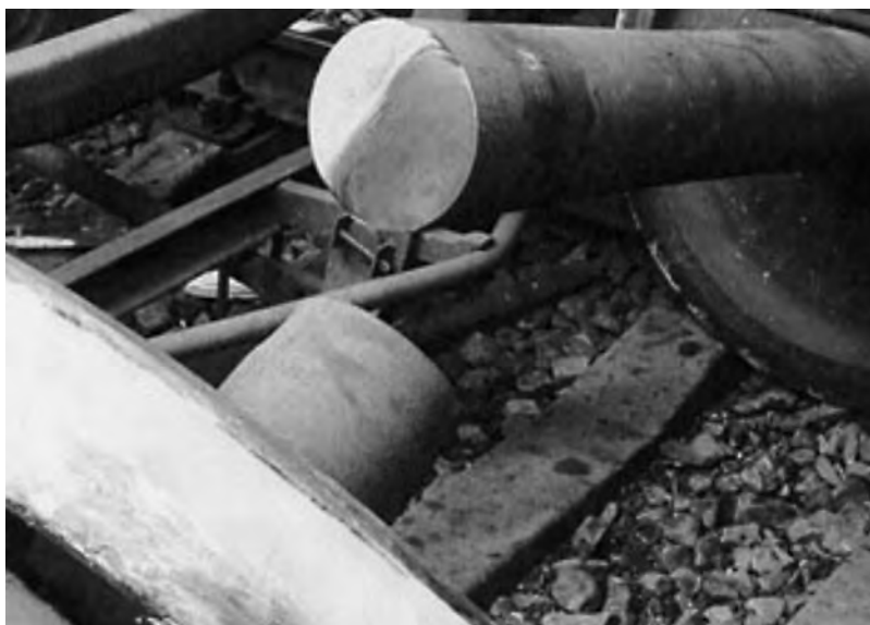
Рис. 1. Излом оси колесной пары грузового вагона
