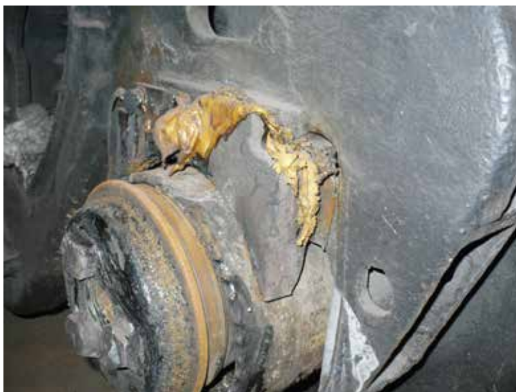
Рис. 8. Возможные неисправности элементов тележек с полимерными вставками
