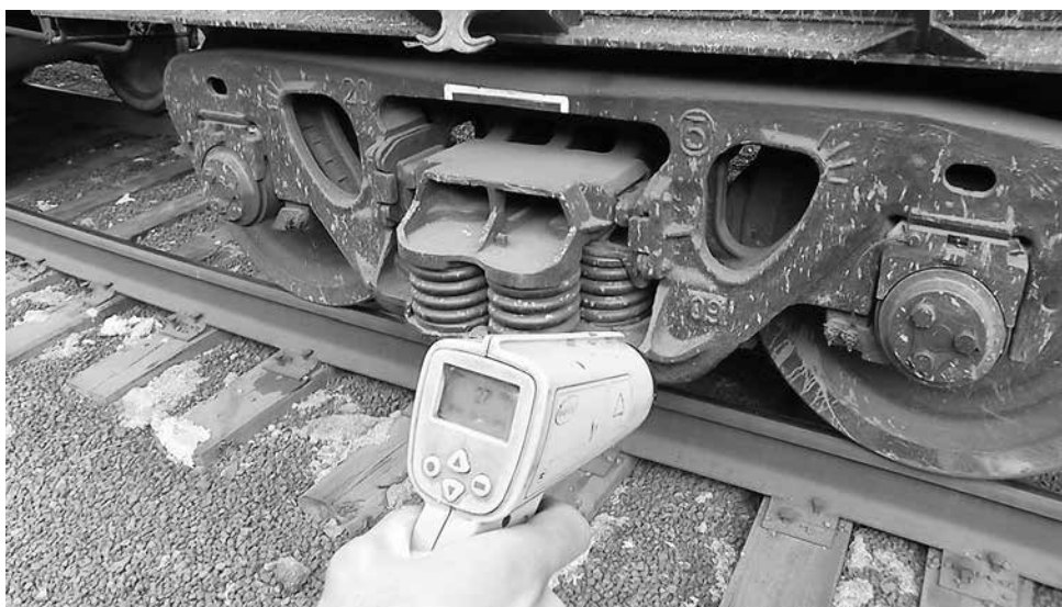
Рис. 3. Измерение температуры на поверхностях элементов вагонов
