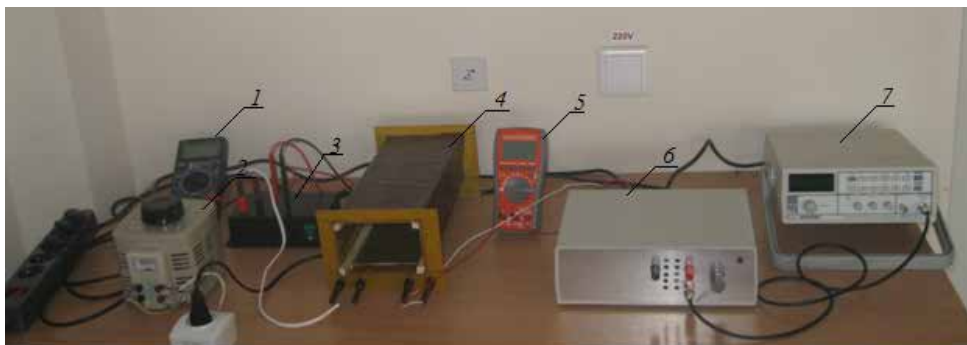
Рис. 2. Устройство для создания переменного магнитного и электрического полей 1 – вольтметр переменного напряжения; 2 – автотрансформатор; 3 – высоковольтный источник переменного напряжения; 4 – соленоид со встроенными металлическими пластинами; 5 – амперметр переменного тока; 6 – реостат регулировки тока (встроен в усилитель); 7 – генератор низкочастотный
