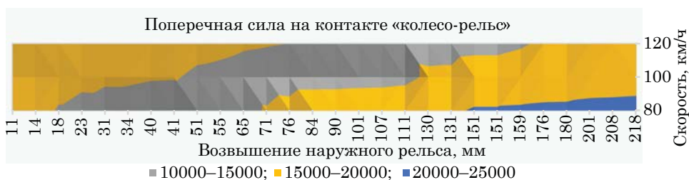
Рис. 9. Изополя поперечных сил на контакте «колесо-рельс» в зависимости от возвышения наружного рельса в кривой и скорости движения
