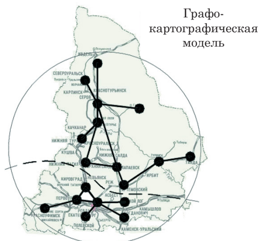
Рис. 3. Разбиение графо-географической модели на доли, соответствующие территориям обслуживания центрами утилизации
