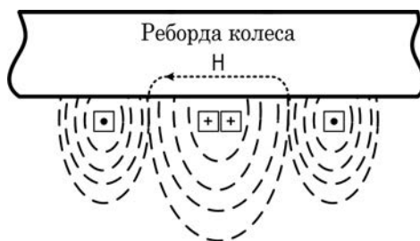
Рис. 4. Условная схема взаимодействия катушек индуктивности ДК с ребордой колеса а – схема взаимодействия по взаимной индукции; б – схема возникновения токов Фуко
