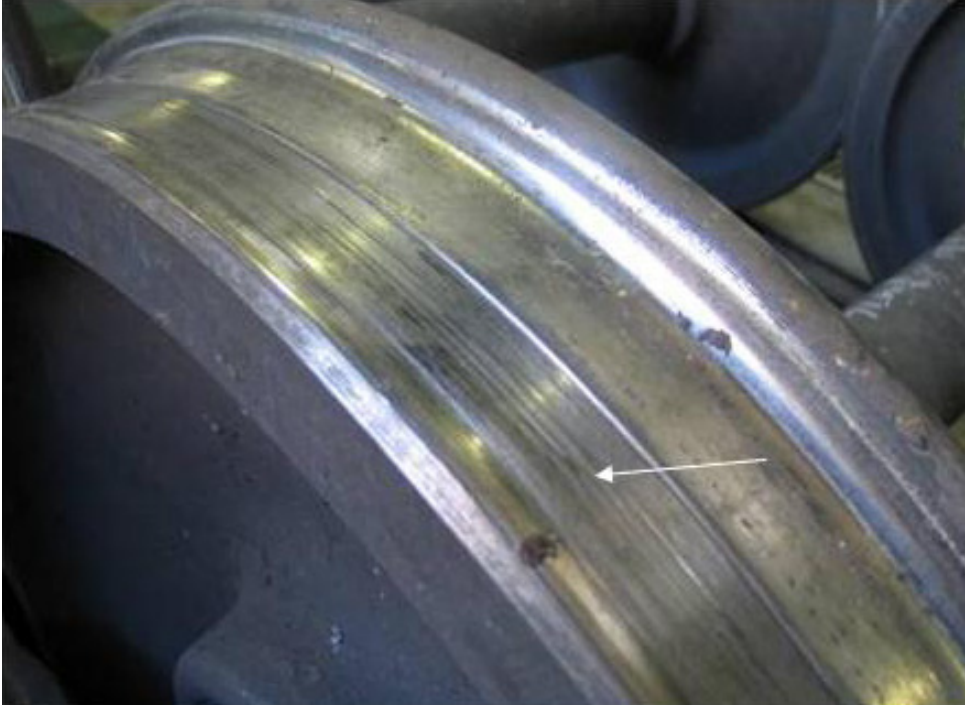
Рис. 1. Кольцевые выработки на поверхности катания колеса (фото авторов)
