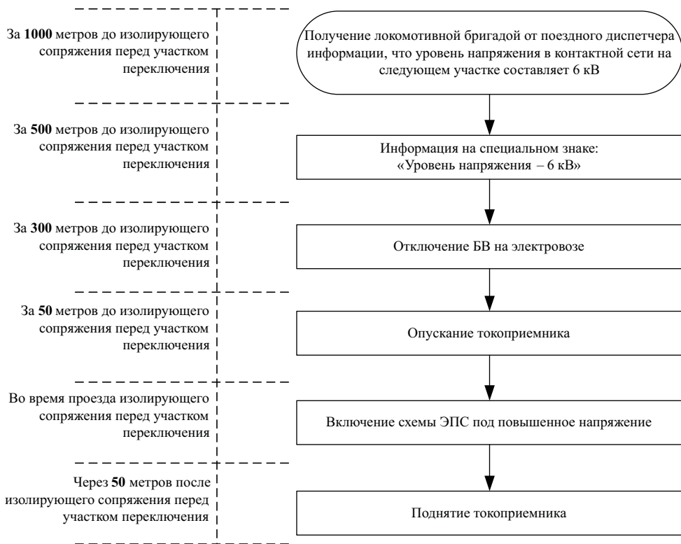
Рис. 4. Алгоритм действий локомотивной бригады по сборке схемы электровоза на повышенное напряжение
