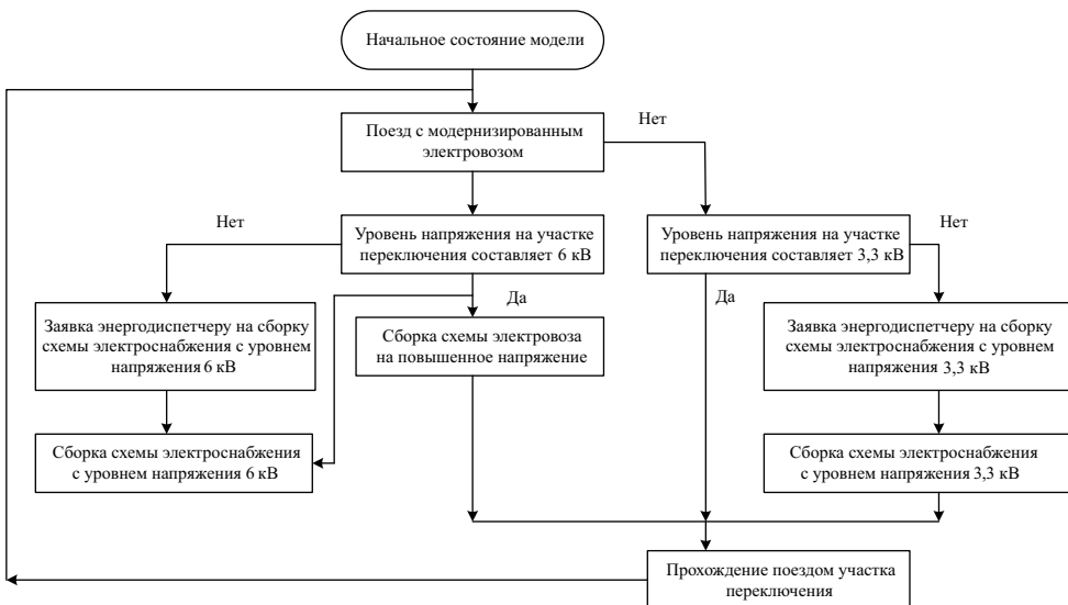
Рис. 2. Модель процесса организации движения поездов при системе электрической тяги постоянного тока повышенного напряжения
