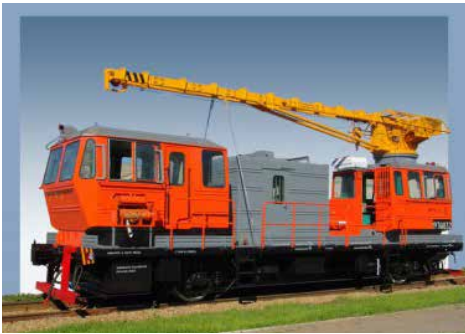
Рис. 1. Компоновка мотовоза погрузочно-транспортного МПТ-6 исп. 2 (общий вид) 1 – кран грузоподъемный; 2 – мастерская; 3 – кабина для перевозки ремонтных бригад; 4 – платформа (рама) мотовоза; 5 – аутригеры; 6 – кабина управления
