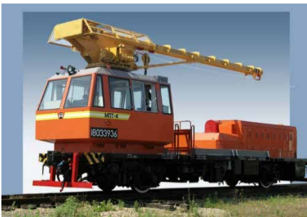
Рис. 2. Компоновка мотовоза погрузочно-транспортного МПТ-4 (общий вид) 1 – кран грузоподъемный; 2 – кабина управления; 3 – растяжка транспортировочная; 4 – дизель-генератор; 5 – электрооборудование; 6 – рама; 7 – топливные баки; 8 – колесные пары; 9 – подвешивание рессорное; 10 – система пескоподачи; 11 – гидropередача универсальная; 12 – пневмосистема; 13 – отключение рессорного подвешивания; 14 – подножки; 15 – аутригер; 16 – путеотчиститель
