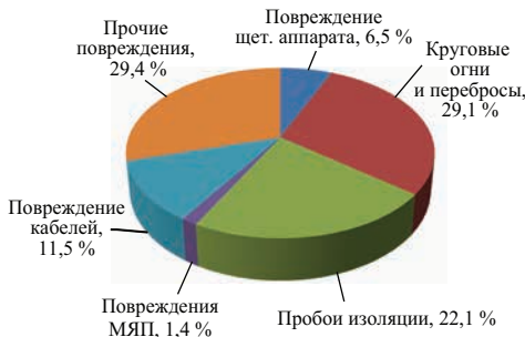
Рис. 3. Причины внеплановых отказов тяговых электродвигателей ЭК-810
