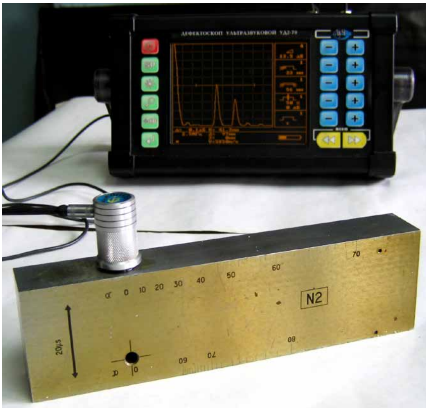
Рис. 2. Отстройка нулевого уровня от БЦО в СО-2
